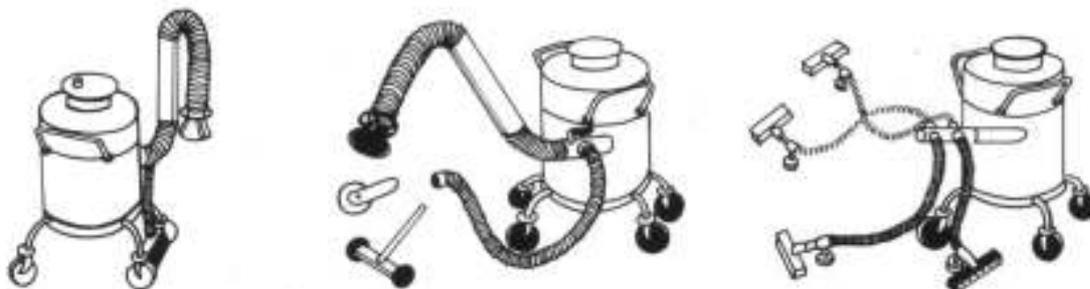
Рис. 51. Передвижные фильтровентиляционные агрегаты Плимут R3, R4, R5 («СовПлим»)
