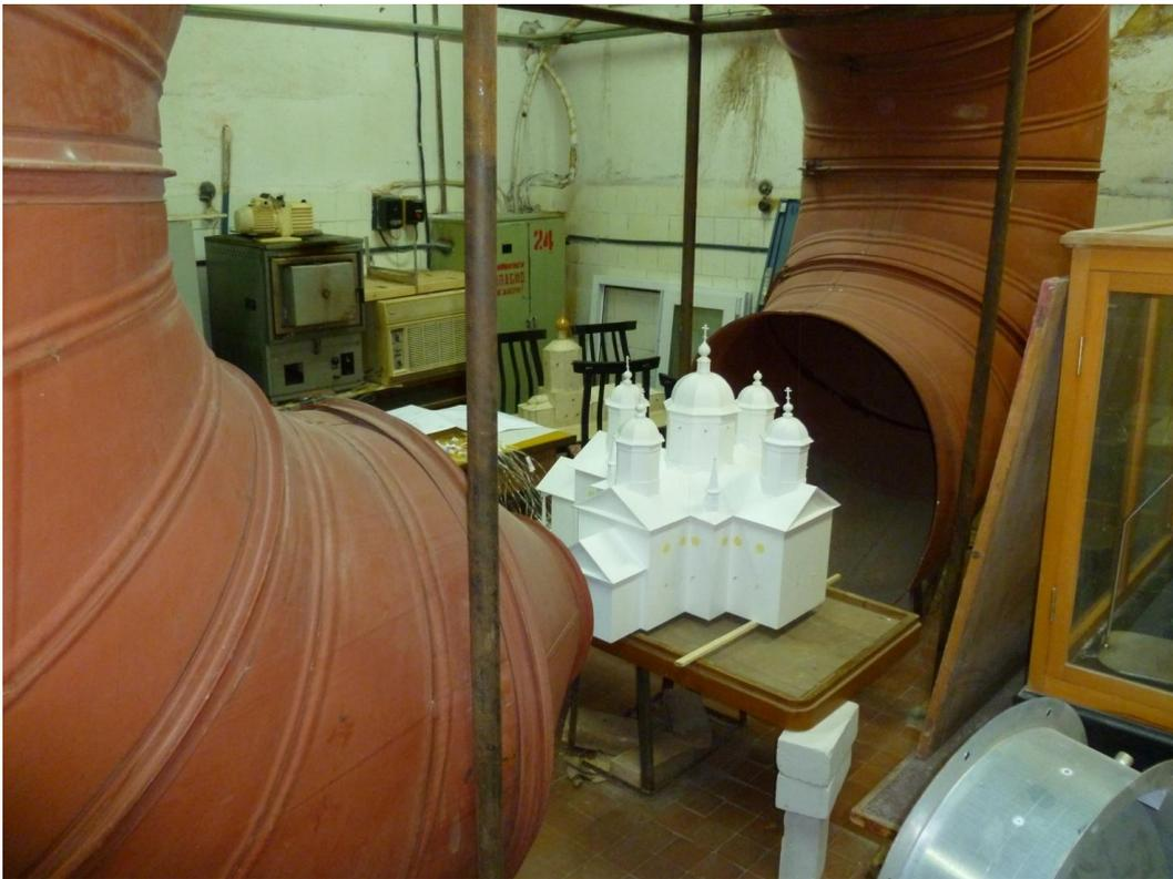
Рис. 3.10. Модель Крестовоздвиженского собора на лабораторной установке
