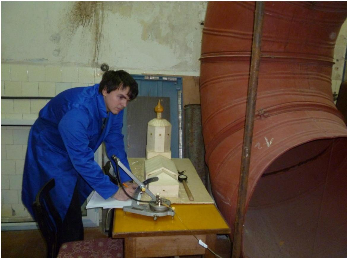
Рис. 3.3. Проведение испытаний на аэродинамической трубе
