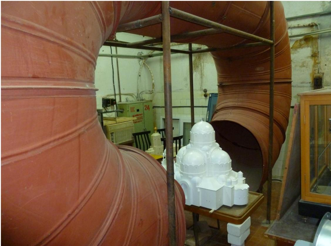
Рис. 3.14. Модель Спасопреображенского собора на лабораторной установке
