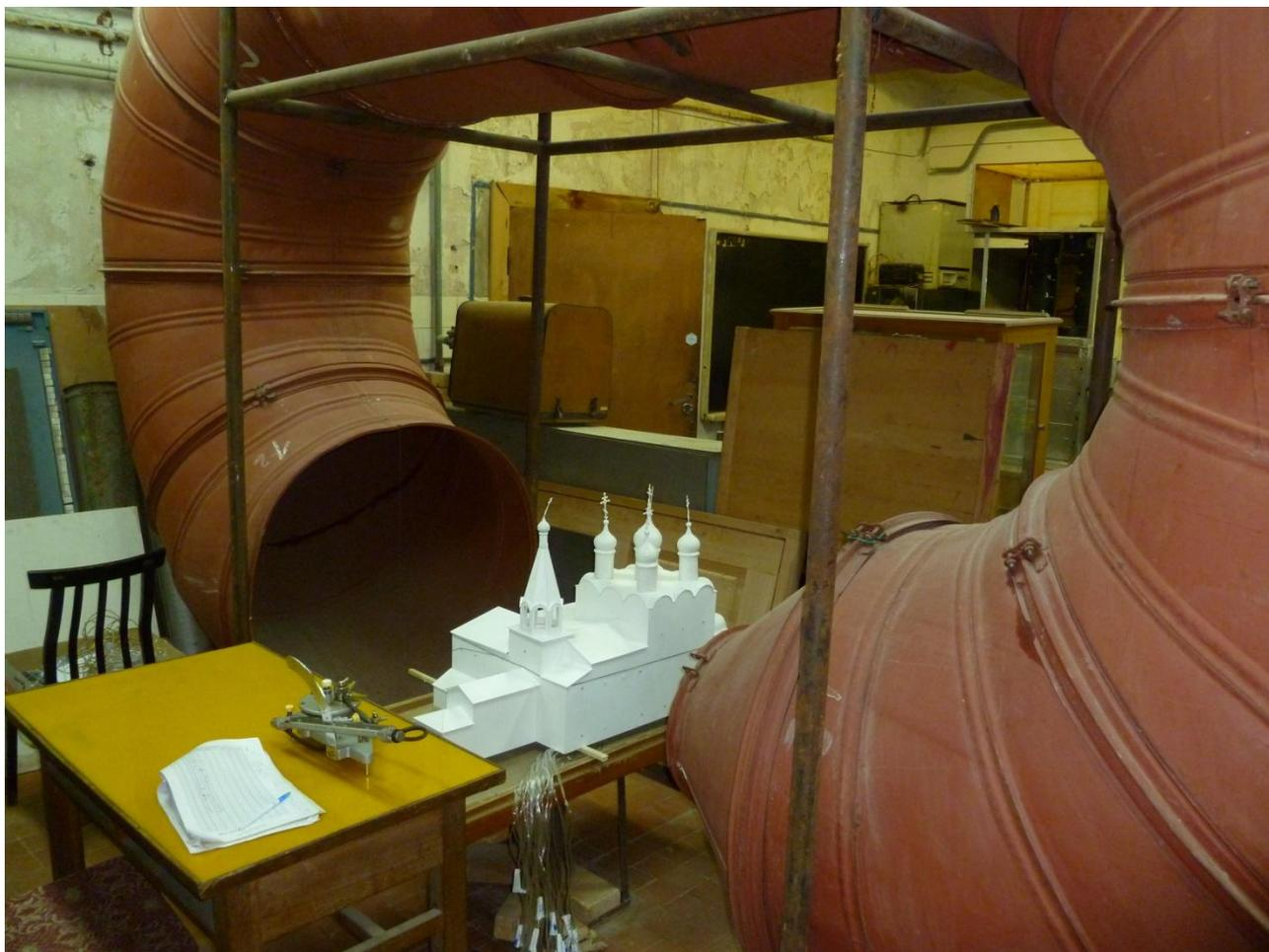
Рис. 3.8. Модель церкви Жен-Мироносиц на лабораторной установке
