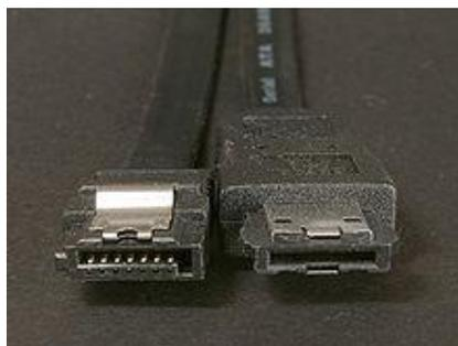
Рис. 5.15. Разъёмы SATA (слева) и eSATA (справа)
