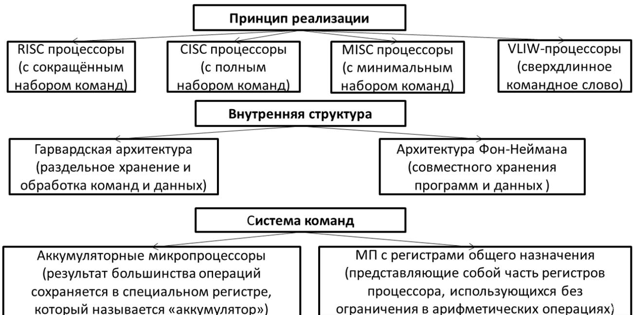
Рис. 3.5. Классификация микропроцессоров
