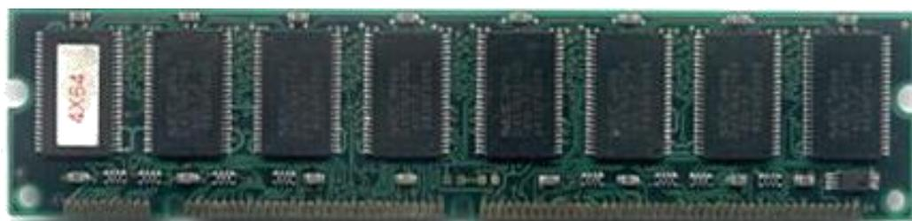
Рис. 6.6. DIMM-модуль
