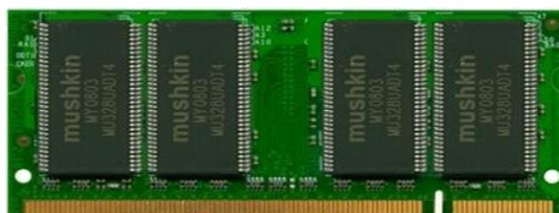
Рис. 6.7. SO-DIMM-модуль
