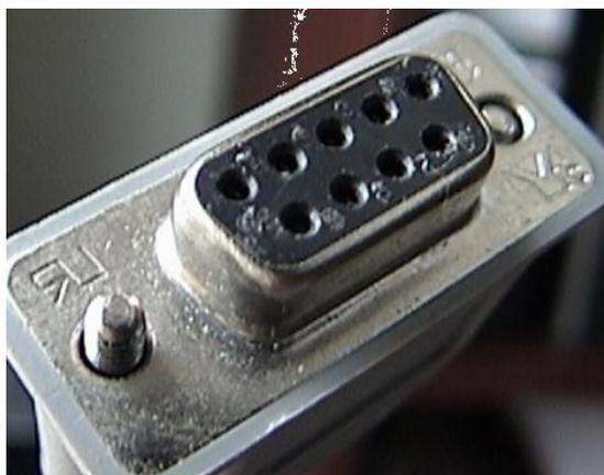
Рис. 5.3. Разъём RS-232
