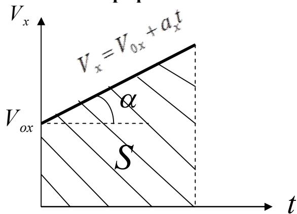
$V_x = V_{0x} + a_x t$  – линейная функция
