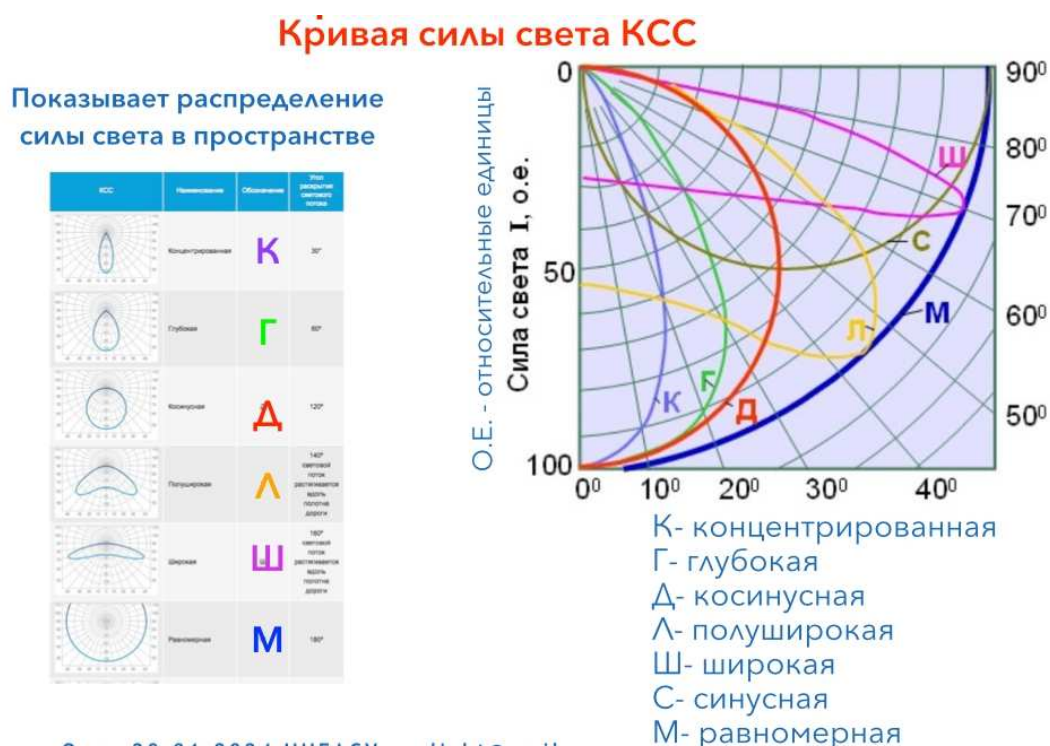
Рис. 8. Различные типы кривых силы света [5]
