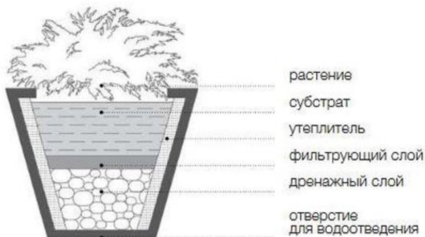
Рис.3. Схема устройства вазона для посадки растений [1]
