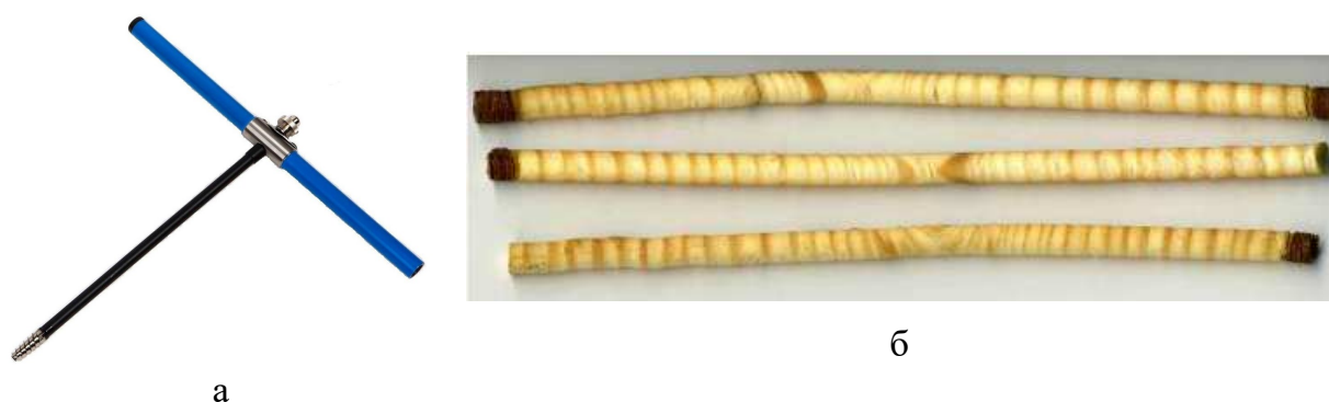
Рис. 1. Возрастной бурав (а) и образцы извлеченной древесины (керны) (б)
