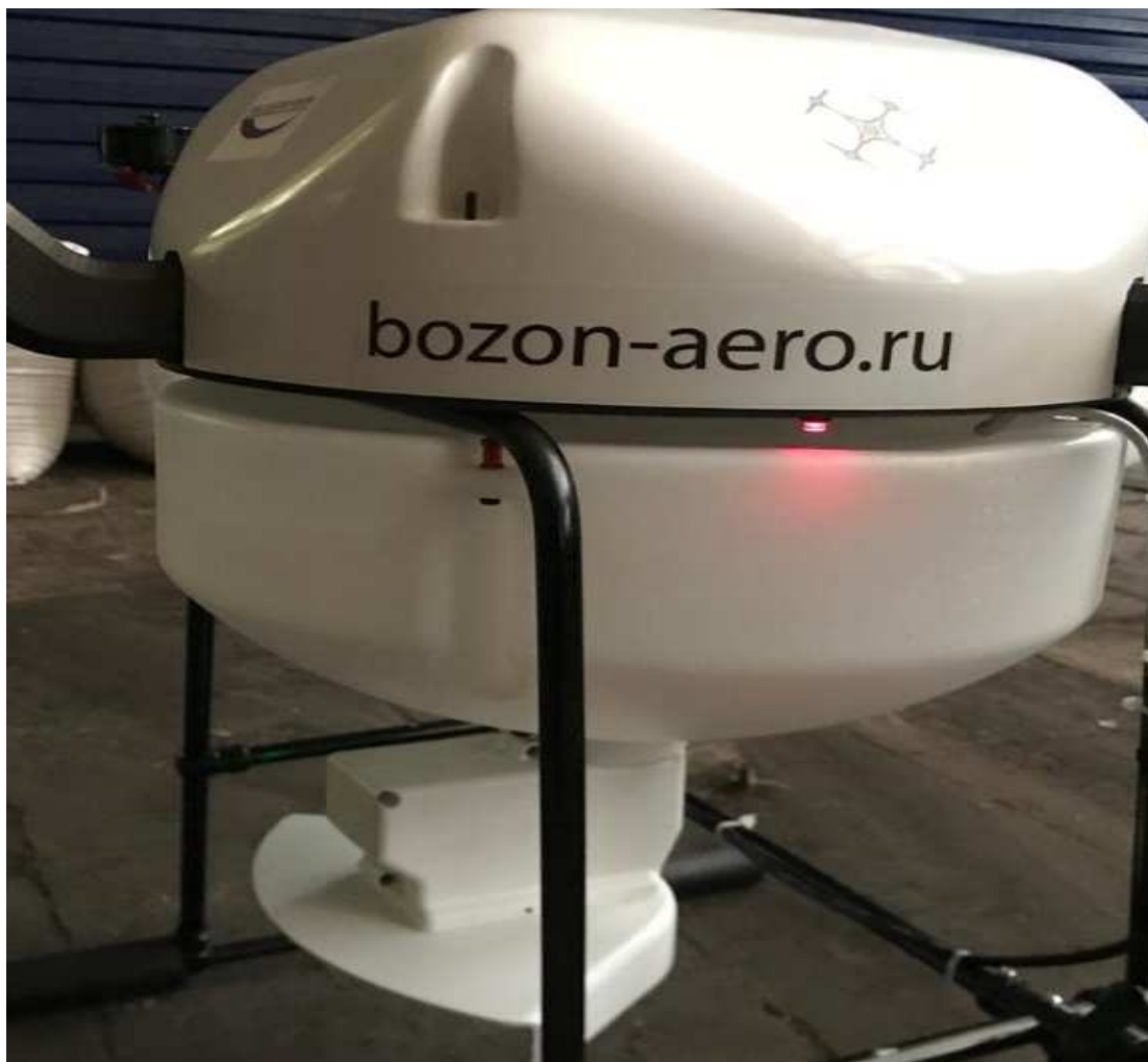
Рисунок 1 – Подвесная сеялка - разбрасыватель «G - 1» в составе универсальной беспилотной авиационной системы «OSA HEXA» на основе БПЛА «ОСА»
