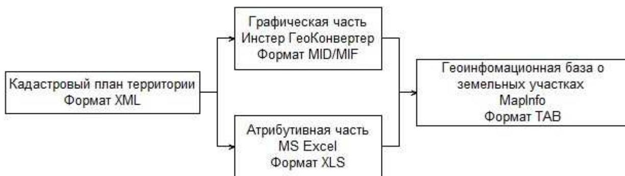
Рисунок 3 – Интеграция сведений из КПТ в геоинформационную базу данных
