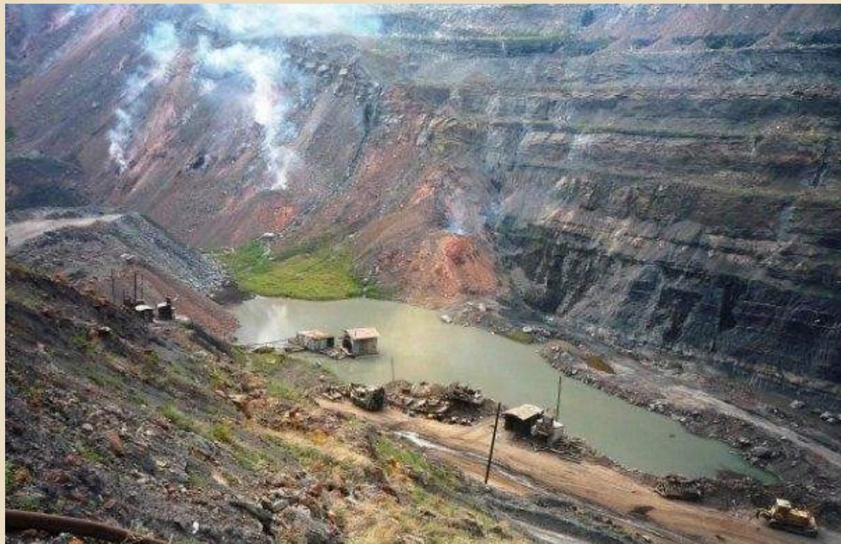
Коркинский угольный разрез в Челябинской области, функционирующий с 1934 г. на месторождении с мощностью угольного пласта 100-200 м
