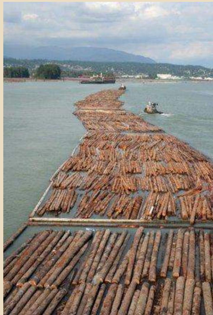
Кошельный сплав древесины
