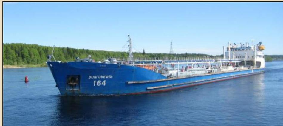
Танкер «Волгонефть» плавания «река – море» грузоподъемностью 5000 т
