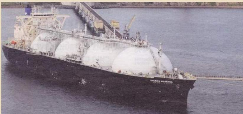
Танкер – газовоз для морских перевозок сжиженного газа
