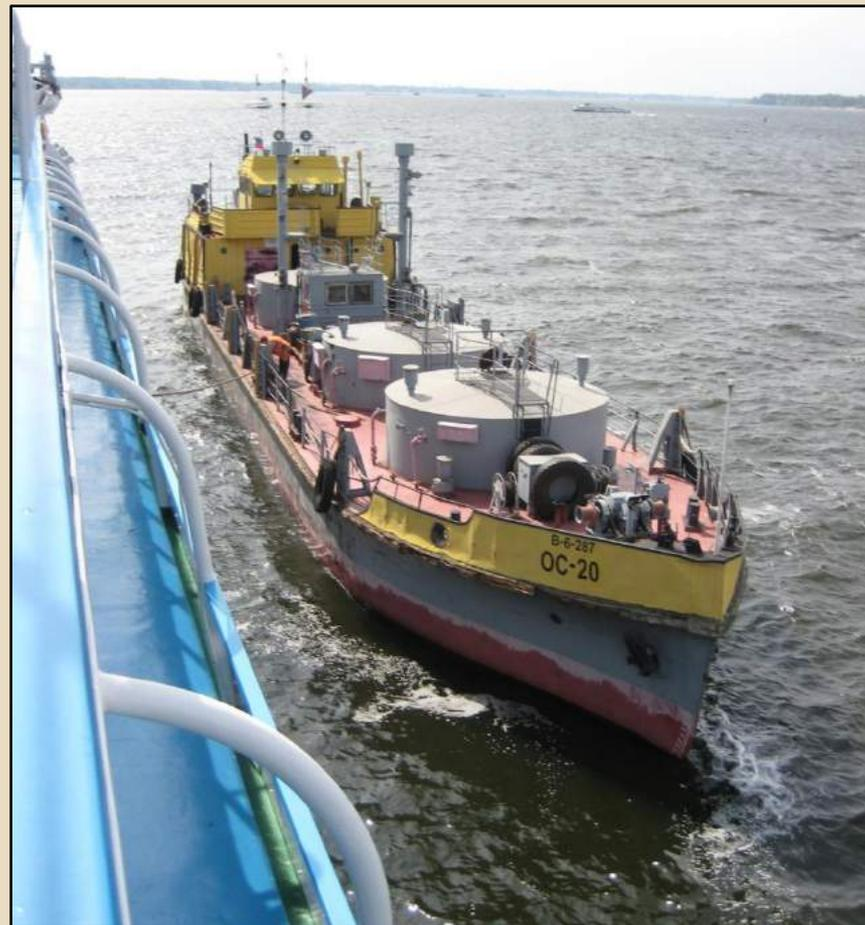
Судно-сборщик сточных вод, причаливающее к пассажирскому теплоходу в порту г. Самары на Саратовском водохранилище. 2012 г.
