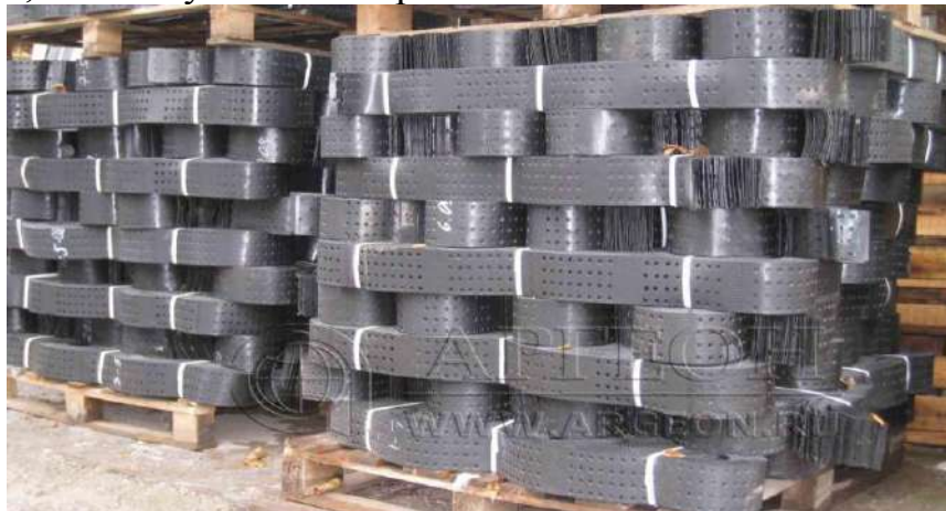
Рисунок 9.25 Герешетки на палетах в транспортном положении
