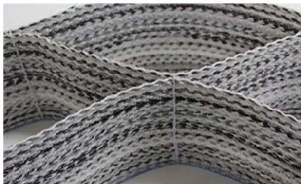
Рис. 7.5 Примеры образцов геосотового материала (пространственных георешеток)
