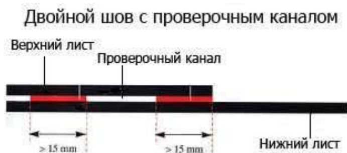
Рисунок 9.55 Двойной шов с воздушным каналом
