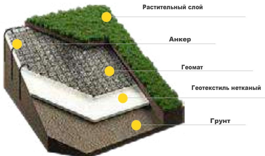
Рис. 7.7 Примеры типичных конструкций с применением ГМ
