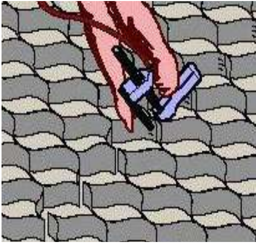
Рисунок 9.37 Соединение смежных секций ГМ*
