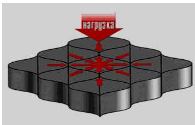
Рисунок 9.23 Схема передачи внешней нагрузки на георешетку
