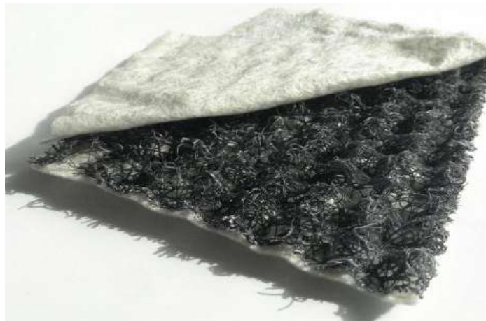
Рис. 7.6 Примеры образцов геокomпозиционных материалов а) армокомпозиаты двухслойные; б) дренажный геокomпозит трехслойный в) противозерозийный геокomпозит
