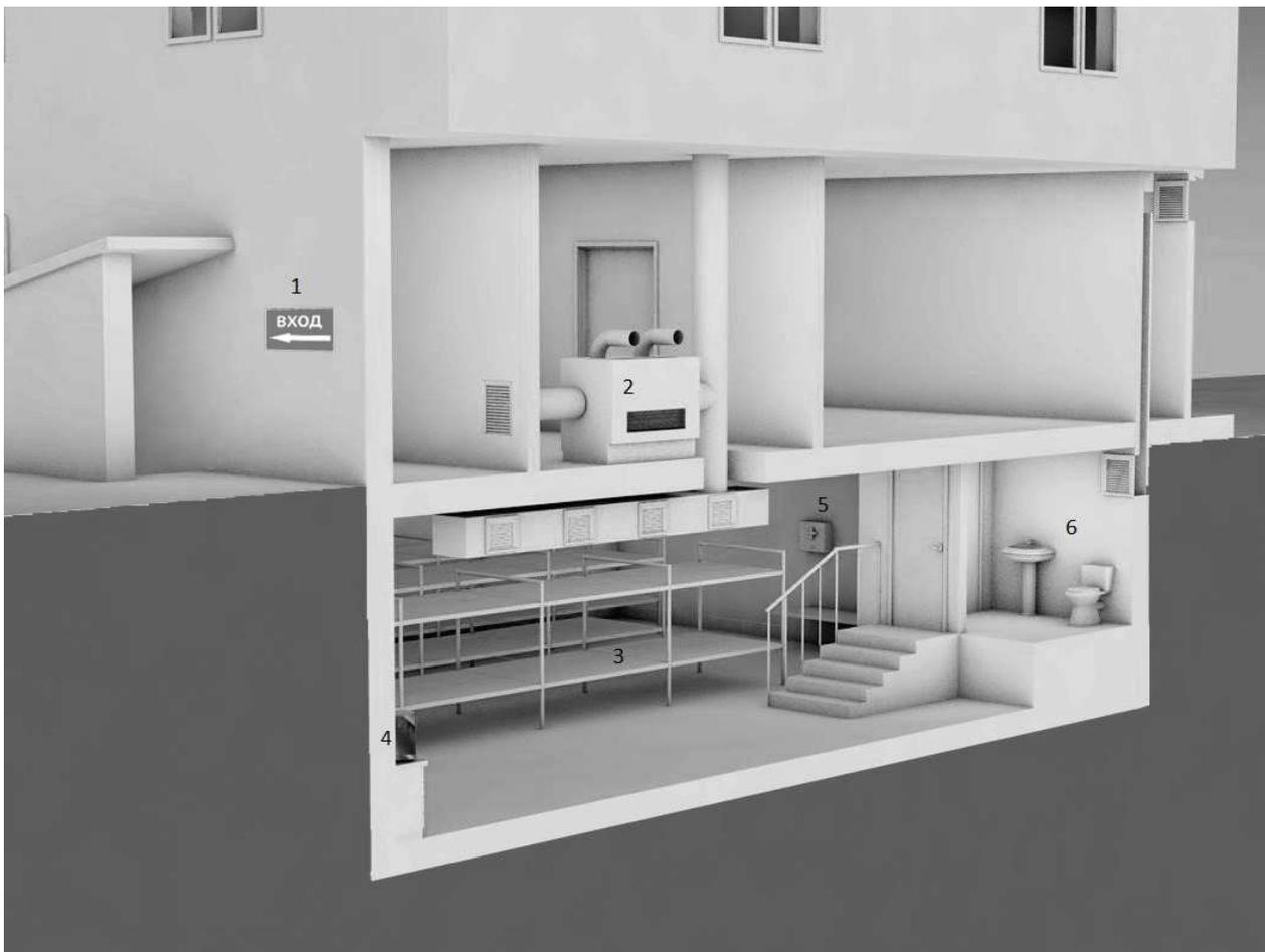
Рисунок 4.1.- Принципиальная схема размещения укрытия в подвале жилого дома, где: 1 – Вход; 2 – Вентилятор; 3 – Помещение для укрываемых; 4 – Бачок для питьевой воды; 5 – Санитарный пост (6 м<sup>2</sup>); 6 – Санитарный узел.
