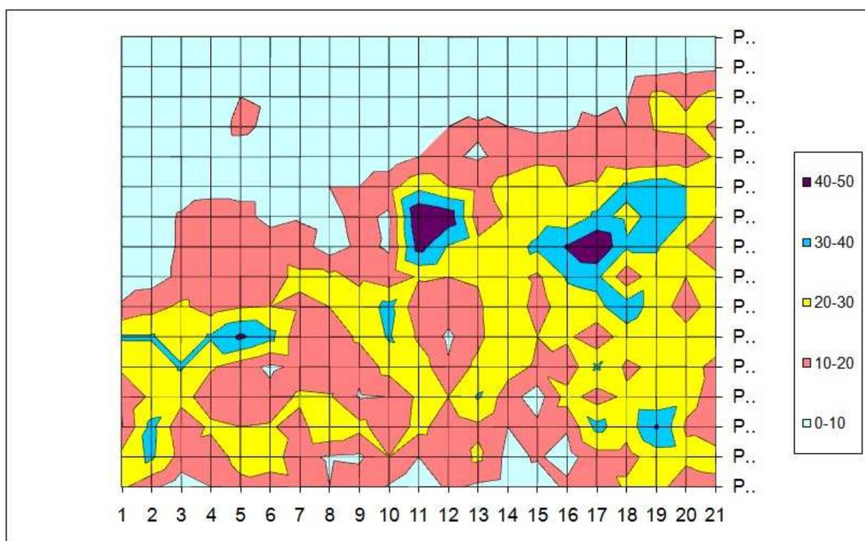
Рис. 4.5. Схема зонирования экспериментальной территории по вертикальной контрастности рельефа, м. абс. выс.
