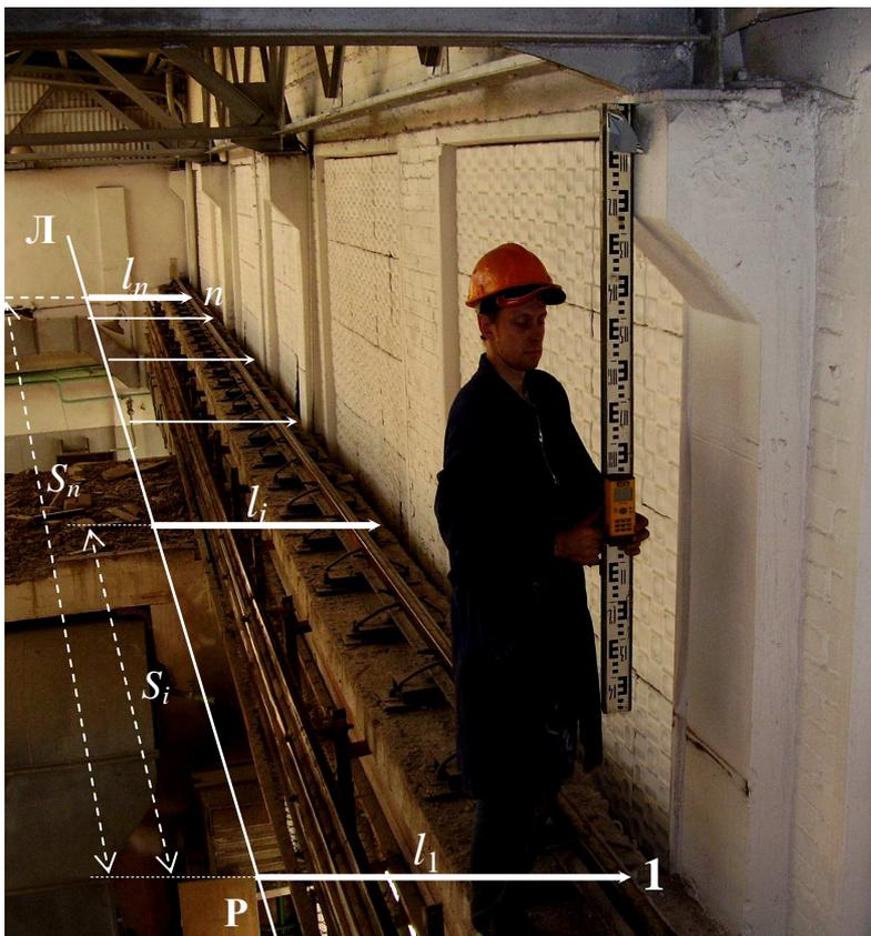
Рис. 135. Схема фотографического способа контроля прямолинейности рельса
