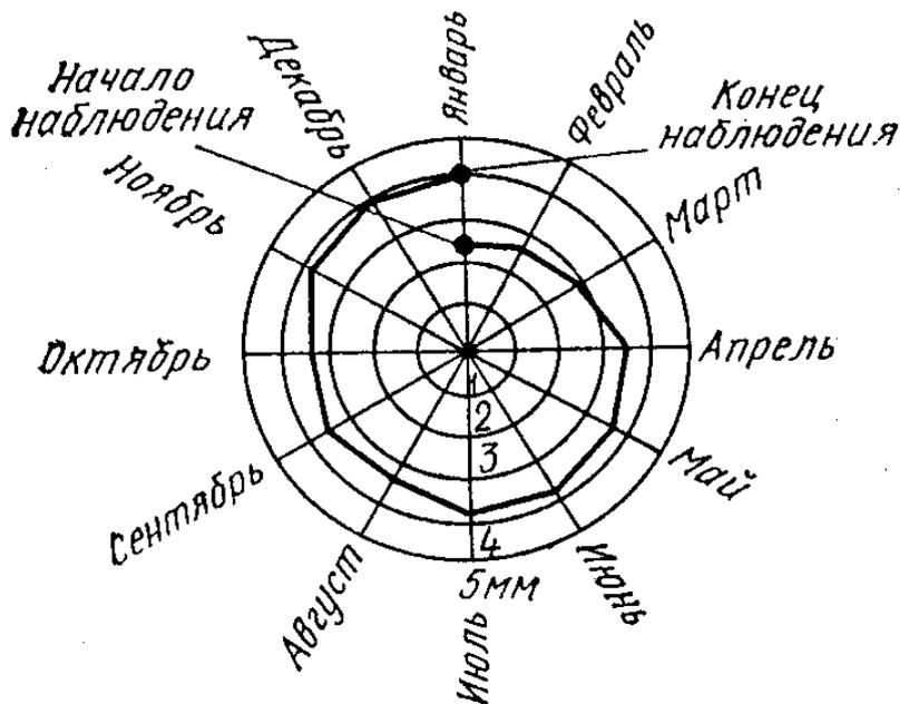
Рис. 166. График хода раскрытия трещины
