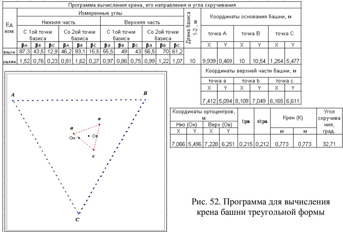
Рис. 52. Программа для вычисления крена башни треугольной формы
