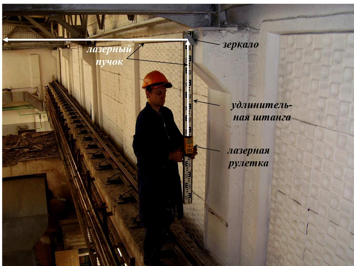
Рис. 94. Пример использования ЛЗУ для измерения расстояния между колоннами в пролёте на уровне их оголовка
