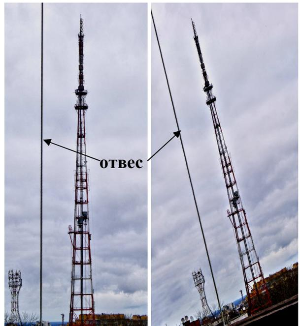
Рис. 26 . Фотография с отвесом перед объективом
