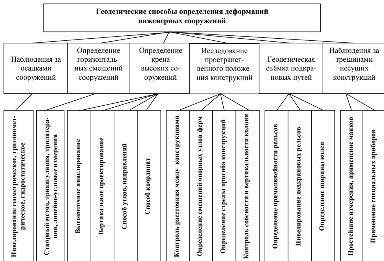
Рис. 1. Классификация способов определения деформаций инженерных сооружений
