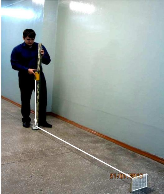
Рис. 89. Измерение базисов с помощью ЛЗУ
