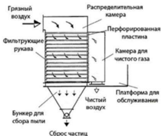
Рисунок 2 – Принципиальная схема рукавного фильтра [1]
