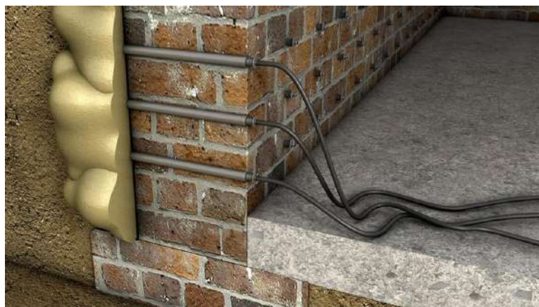
Рисунок 4 – Применение инъектирования ремонтных составов в шпуров для усиления каменной конструкции (Источник: [5])
