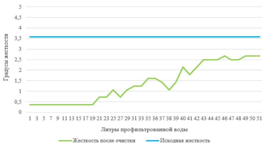
Рисунок 1 – Результаты эксперимента по умягчению водопроводной воды путем использования бытового фильтрующего картриджа
