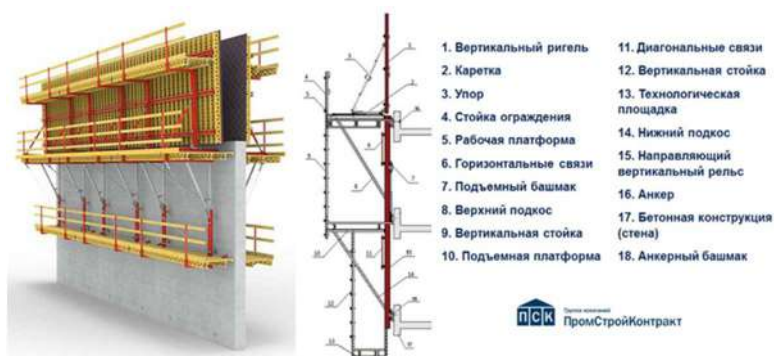
Рис. 3. Гидравлическая самоподъемная опалубочная система: состав и внешний вид
