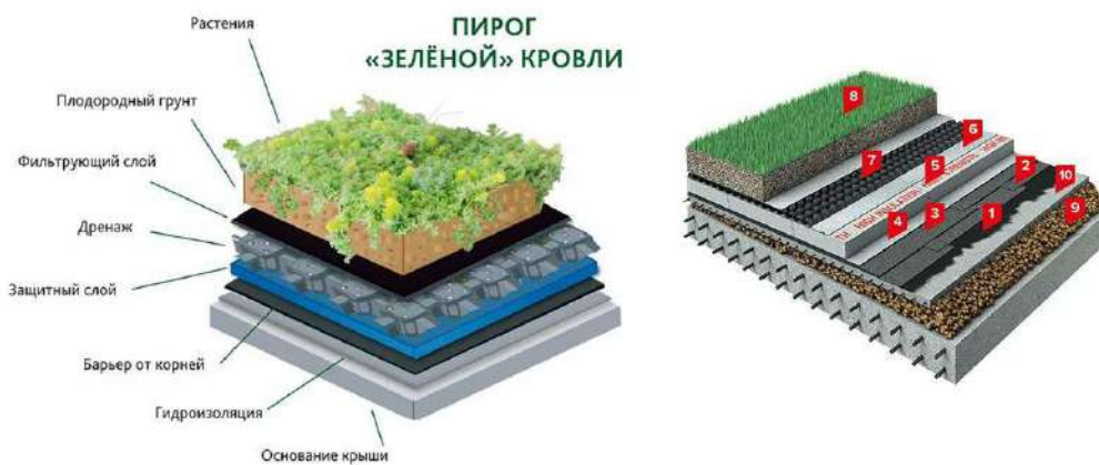
Рис. 1. Структура слоёв «зелёной» кровли «ТехноНИКОЛЬ» [3].
