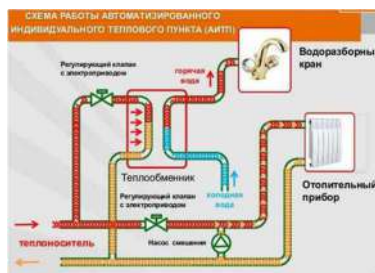
Рис. 1. Схема теплового пункта
