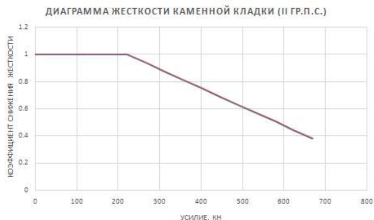
Рис. 4. Диаграмма изменения жесткости кладки
