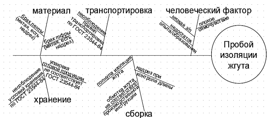
Рис. 2. Диаграмма причин и следствий для жгутов проводов
