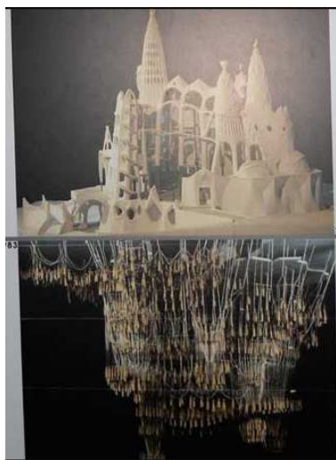
Рис.4. Подвесная цепная модель Гауди.
