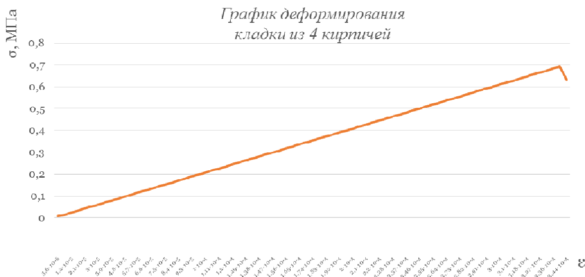
Рис. 6. График деформирования кладки из 4-х кирпичей
