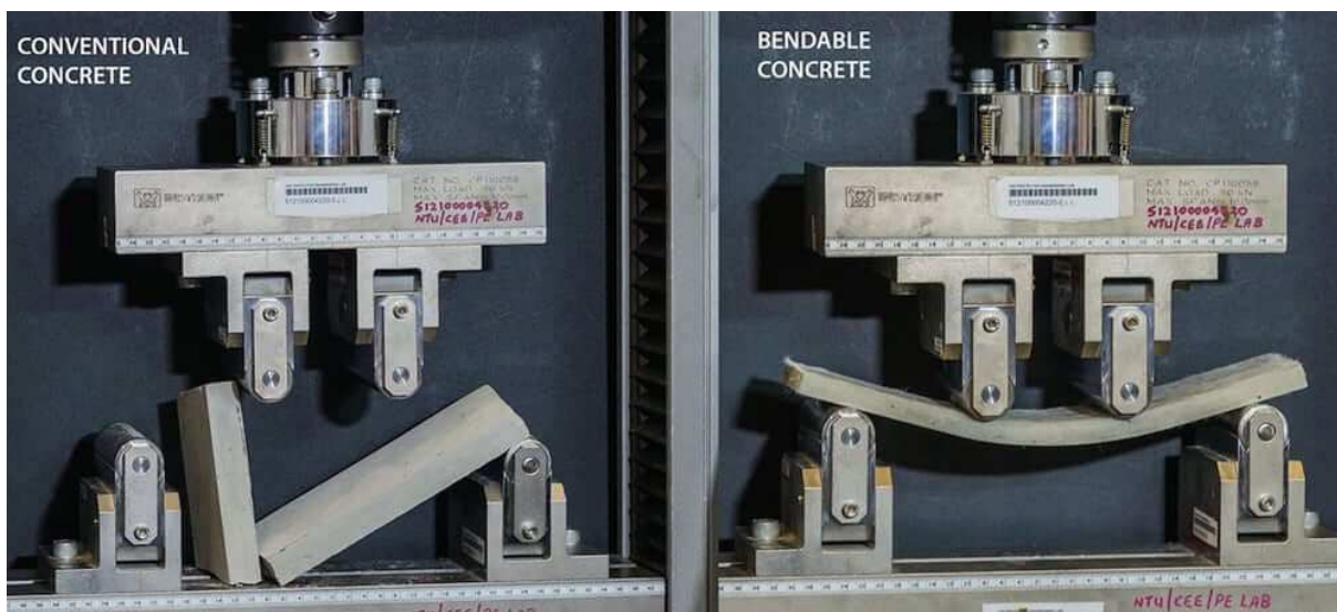
Рис.2. Образцы обычного и гибкого бетона под давлением изгибающей нагрузки одинаковой величины.
