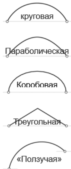
Рис. 5. Общепринятая классификация форм арок и методы образования поверхностей (образующие и траектории).
