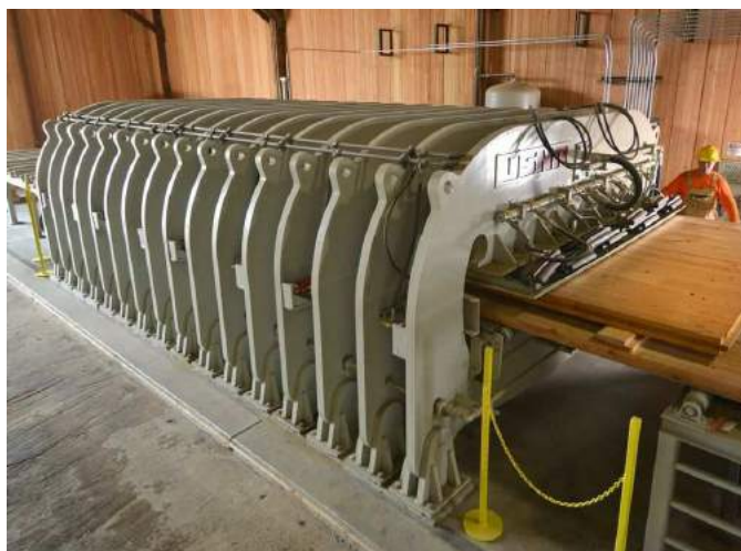
Рис.2. Склеивание слоев CLT-панели
