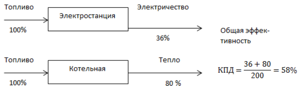
Рис. 1. Эффективность раздельного производства теплоты и электричества
