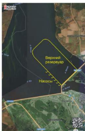
Рисунок 1 – Предлагаемый вариант строительства верхнего резервуара для перекачки воды из водохранилища с помощью плавучих фотоэлектрических панелей (слева). Схема функционирования симбиоза фотоэлектрической станции, расположенной в верхнем водоеме гидроаккумулирующей станции, включающей
