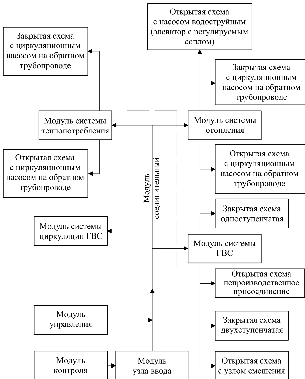
Рис. 3. Структурная схема БИТП с возможными модулями
