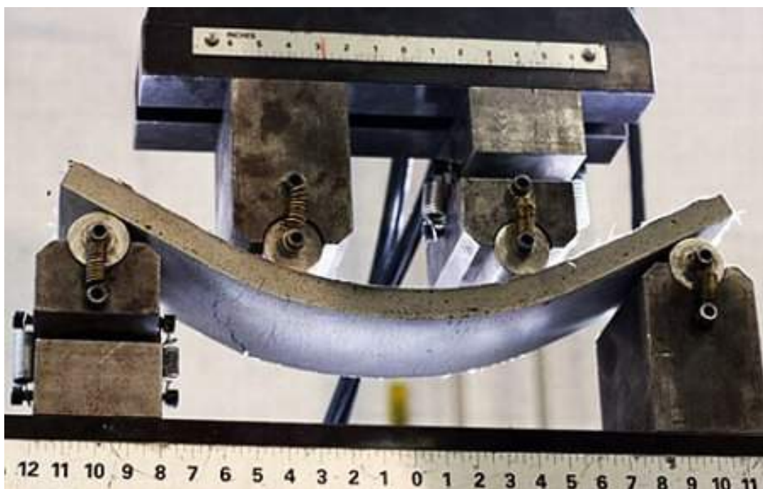
Рис.1. Образец гибкого бетона, проходящего испытание на изгиб
