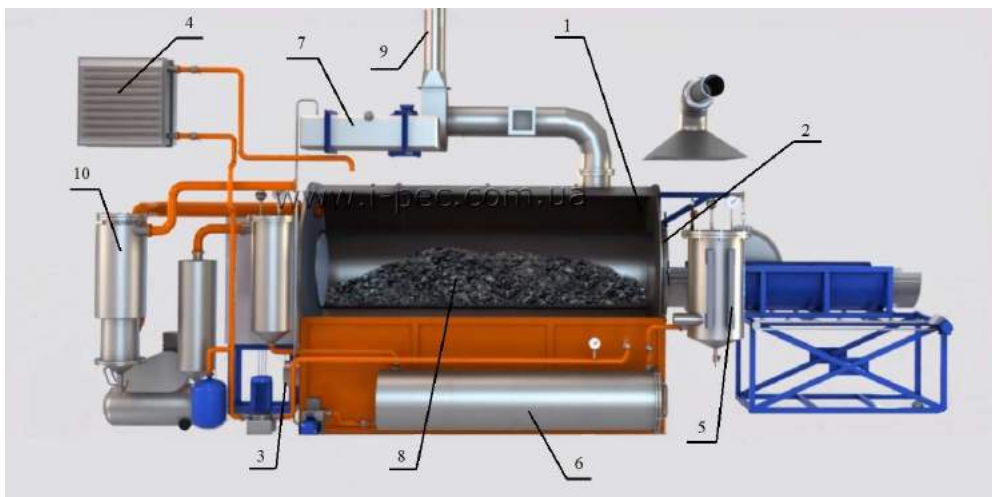
Рисунок 1 - Схема мусоросжигательной установки:
