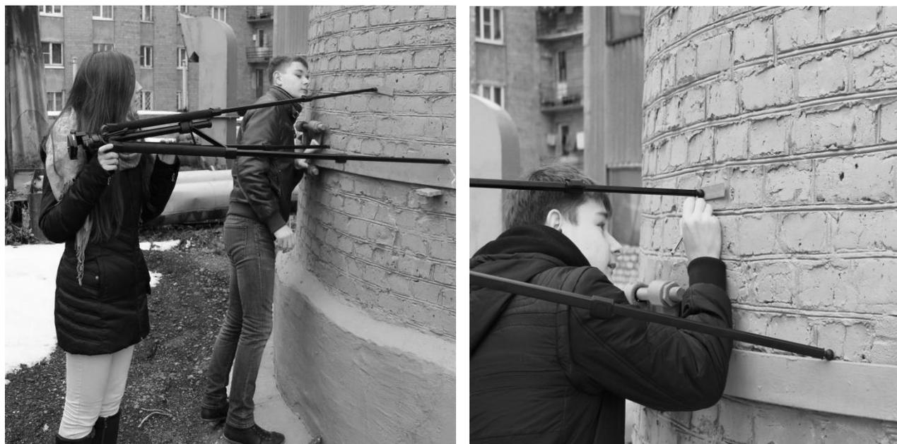
Рис. 2. Определение направления визирного приспособления на штатив, расположенный в точках  $A_1, A_2, A_3, A_4$  и отмечание на трубе точки его касания
