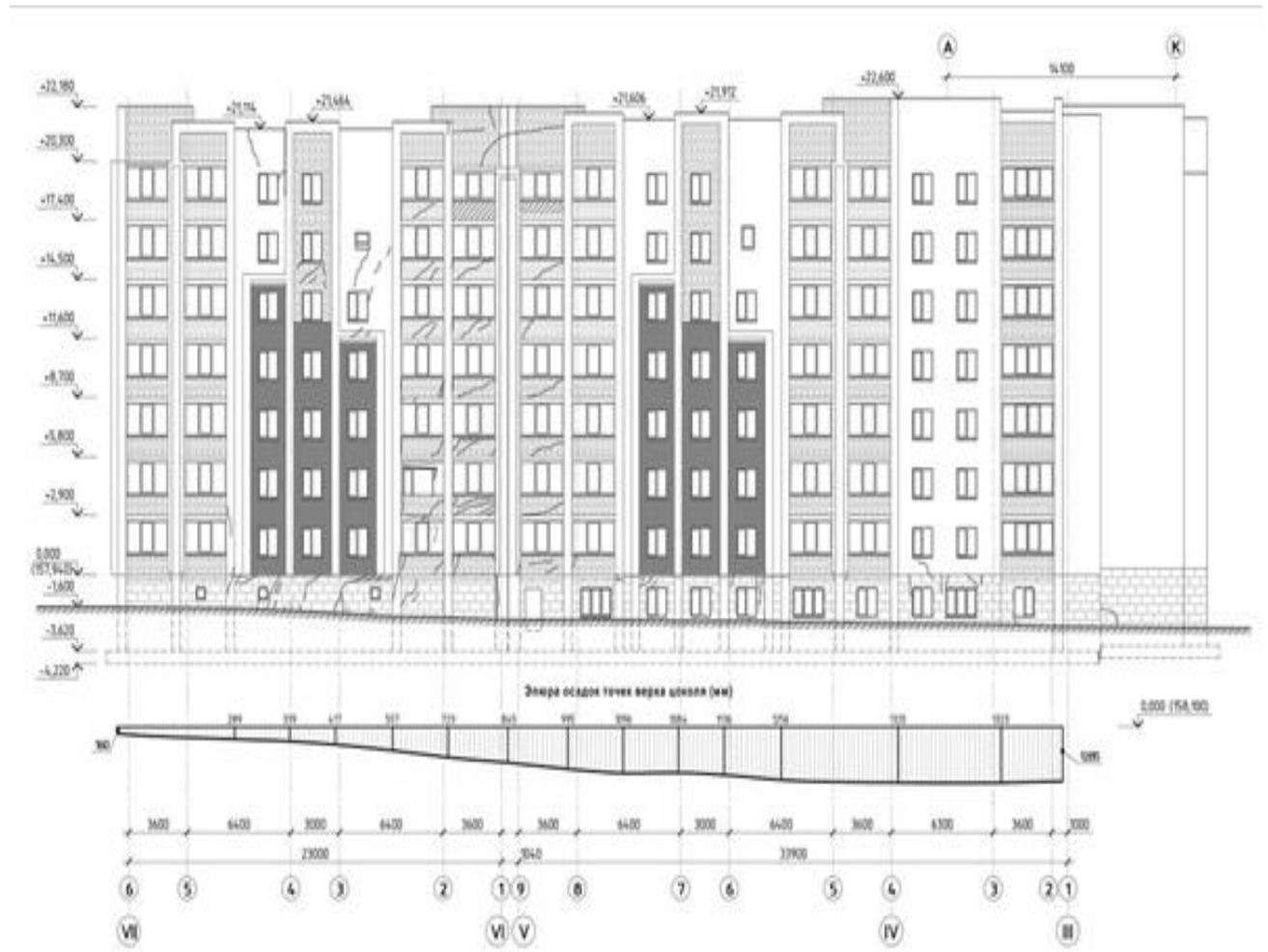
Рис. 1. Картограмма расположения трещин в наружных стенах секций №3 и №2, ориентированных по оси «К», на участке в осях VII-III
