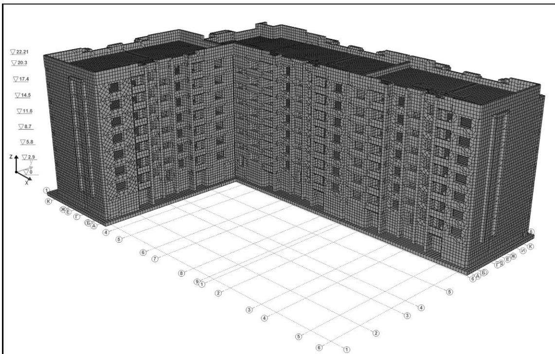
Рис. 4. Трёхмерная конечно-элементная модель жилого дома, расположенного на улице Ломоносова, 15 в Нижнем Новгороде. Вид со двора
