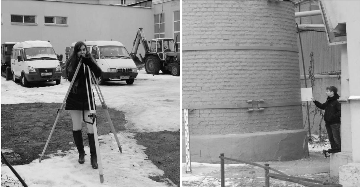
Рис. 3. Определение расстояний:  $d$  до трубы и  $l$  до точки касания
