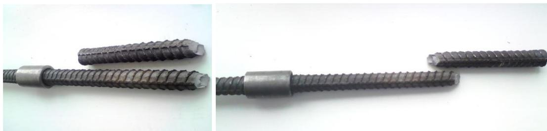
Рис. 2. Результаты испытаний образцов на растяжение
