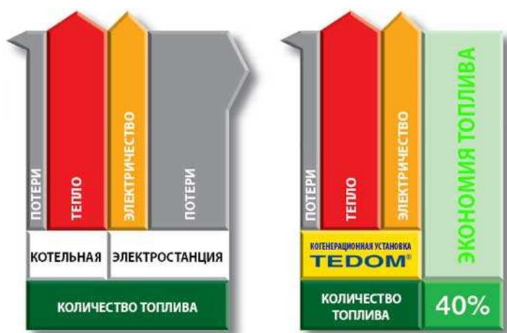
Рис.1 – Распределение топлива при раздельной и совместной выработке тепла и электричества
