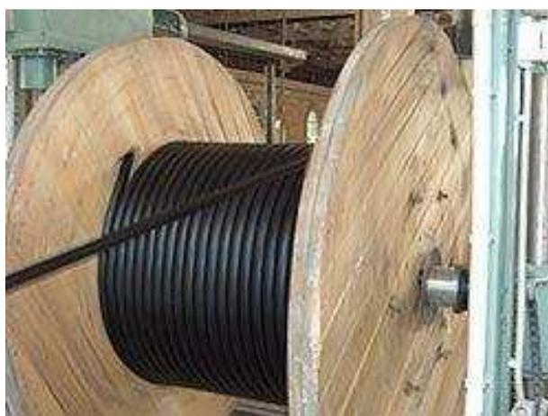
Рис. 2. Трубы ПНД, намотанные на барабан
