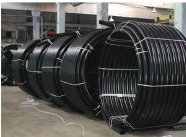
Рис. 1. Полиэтиленовые трубы в бухтах
