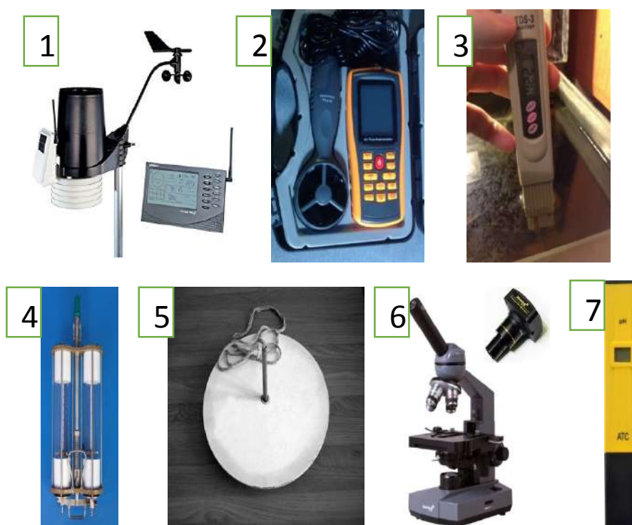
Рис. 10.2. Состав мобильного измерительного комплекса, включающий 1- профессиональную Интернет метеостанцию, 2- анемометр Мегеон 1103, 3- термометр для измерения температуры воды, 4 - батометр Молчанова, 5- диск Секки, 6- микроскоп с цифровой камерой, 7- рН-метр.
