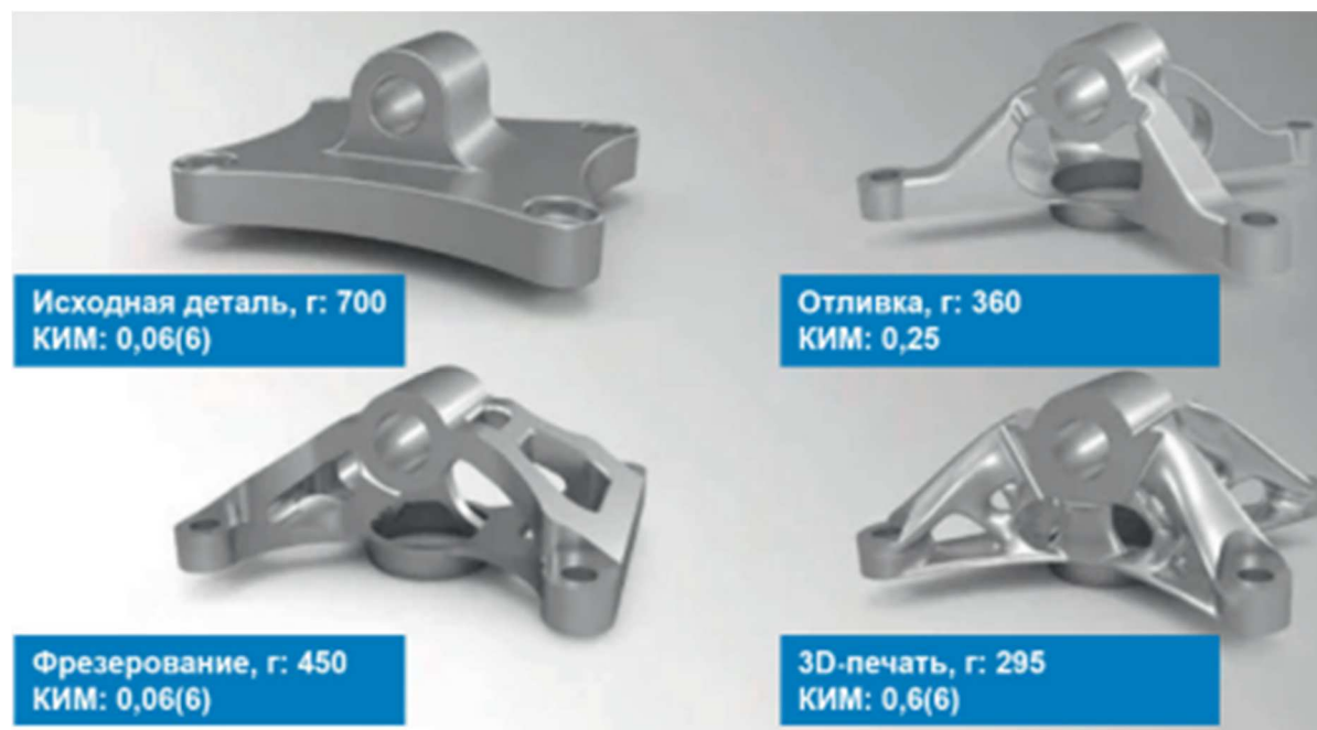
Рис. 1.1. Примеры топологической оптимизации кронштейна, выполнено в Dassault Systemes 3D Experience [14]
