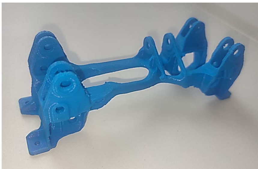
Рис. 3.22. Готовая деталь с удаленными поддержками
