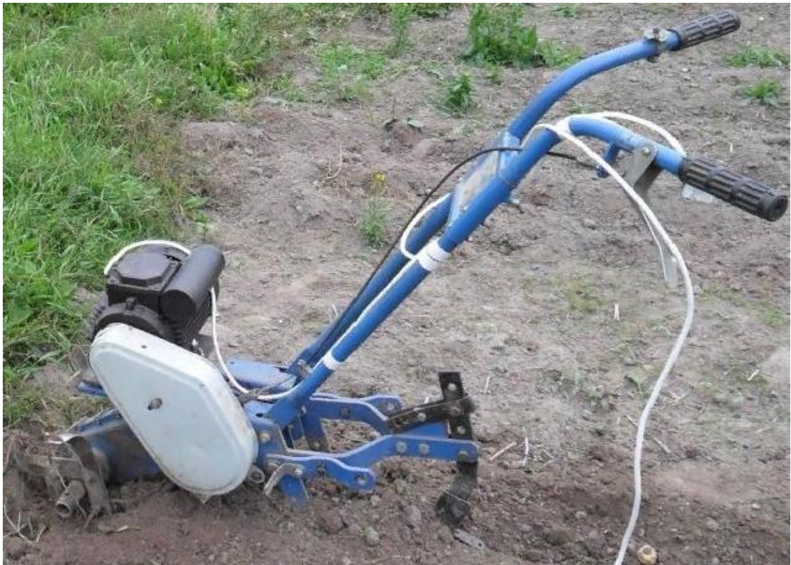
Рис. 2.44. Мотокультиватор с ходовым оборудованием в виде фрез, рабочее оборудование – плуг
