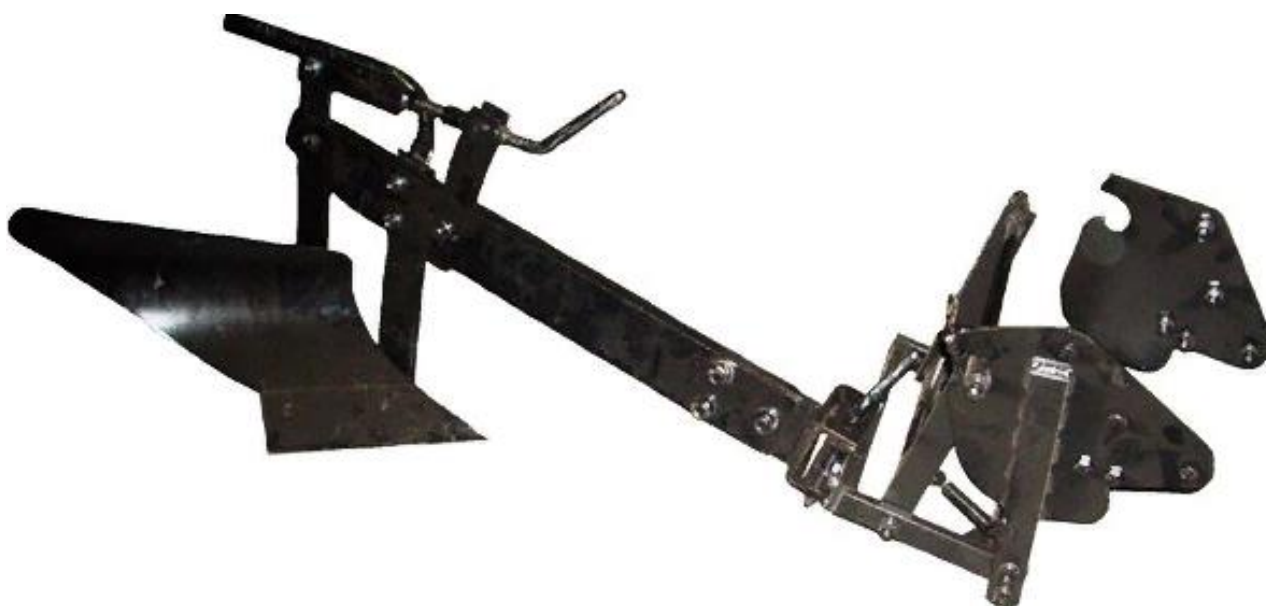
Рис. 2.17. Плуг с возможностью регулировки заглубления
