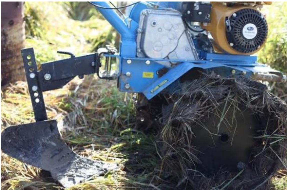
Рис. 2.44. Мотокультиватор с ходовым оборудованием в виде фрез, рабочее оборудование – плуг
