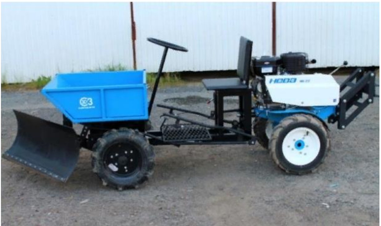
Рис. 2.43. Адапторы; а – безрулевой; б – рулевой адаптор совмещающий в себе функции четырех механизмов: грейдер, минитрактор, самосвал и пахотный агрегат
