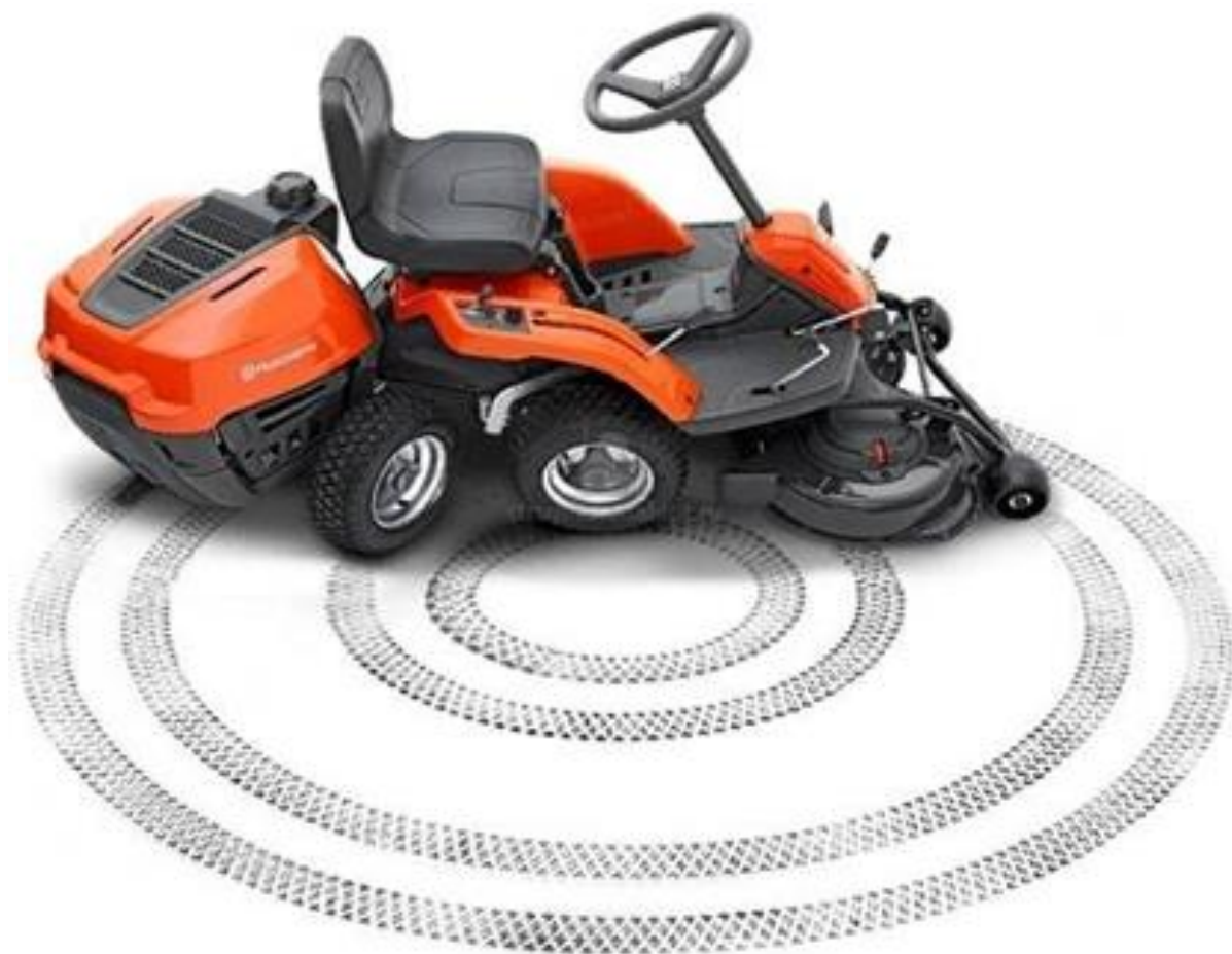
Рис. 1.10. Райдер с шарнирно-сочлененным поворотным управлением
