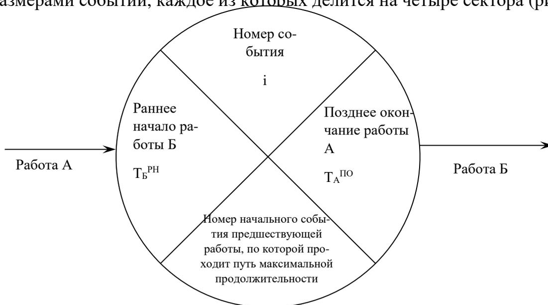
Рис. 8.1. Содержание секторов событий при расчёте на графике
