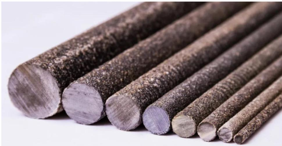
Рисунок 1.4 – Композитная арматура с песочной посыпкой [7]
