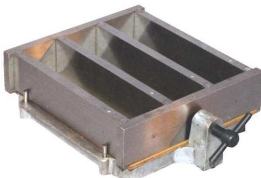
Рисунок 3.6 – Форма для изготовления образцов-балочек
