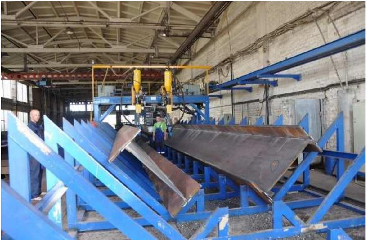
Рис. 3.31 Сварка двумя сварочными головками
