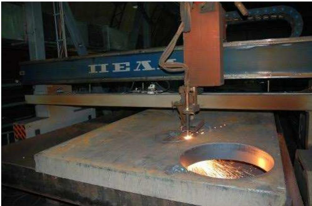
Рис. 3.46 Газорезательная машина с ЧПУ
