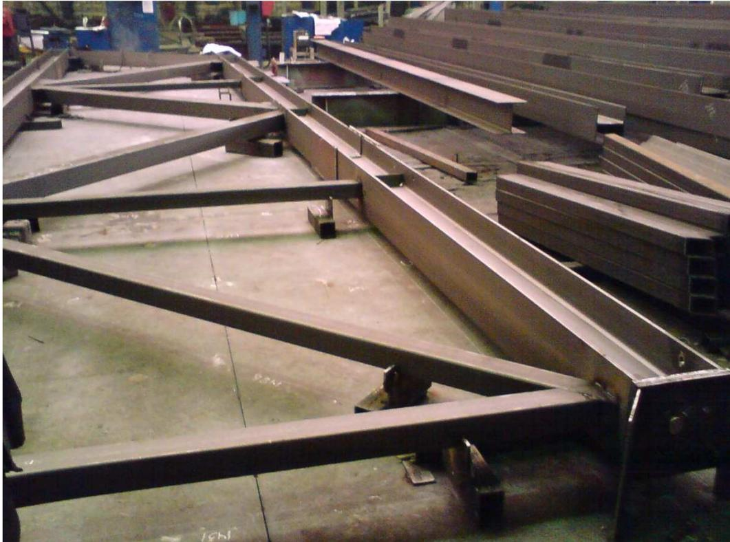
Рис. 6.51 Конструкция раскосов
