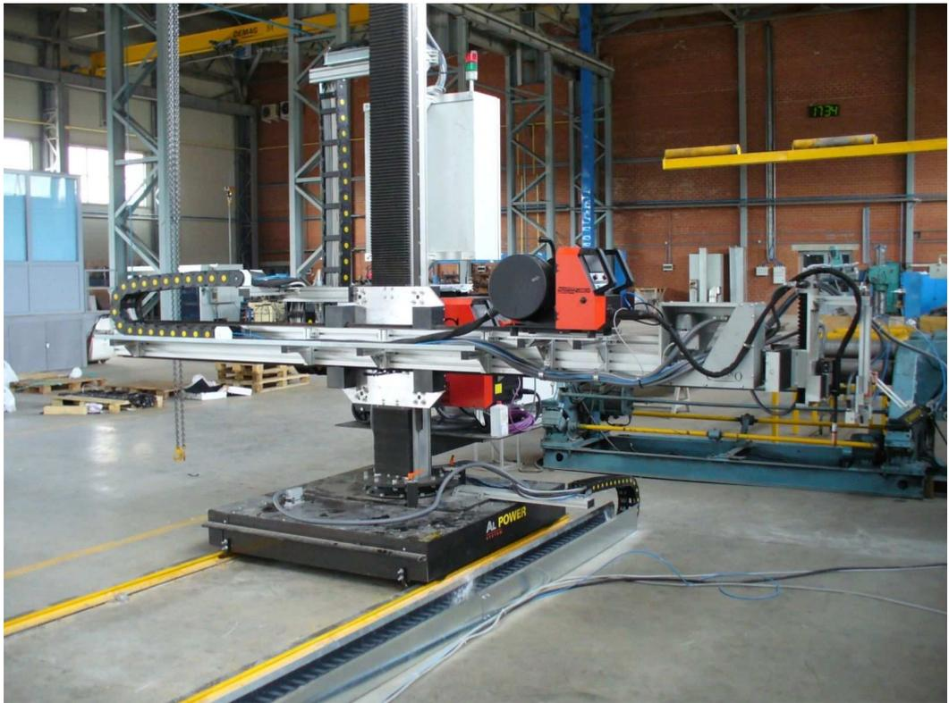
Рис. 3.5 Аппарат для выполнения сварных швов для широких стенок балок
