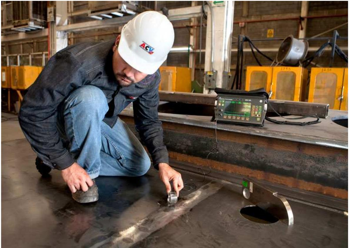
Рис. 3.9 Ультразвуковой контроль швов
