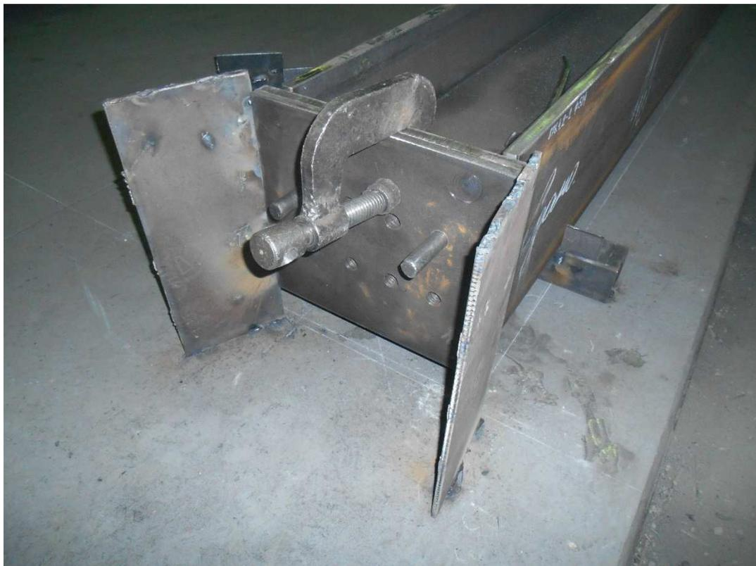
Рис. 6.43 Соединение фланцев
