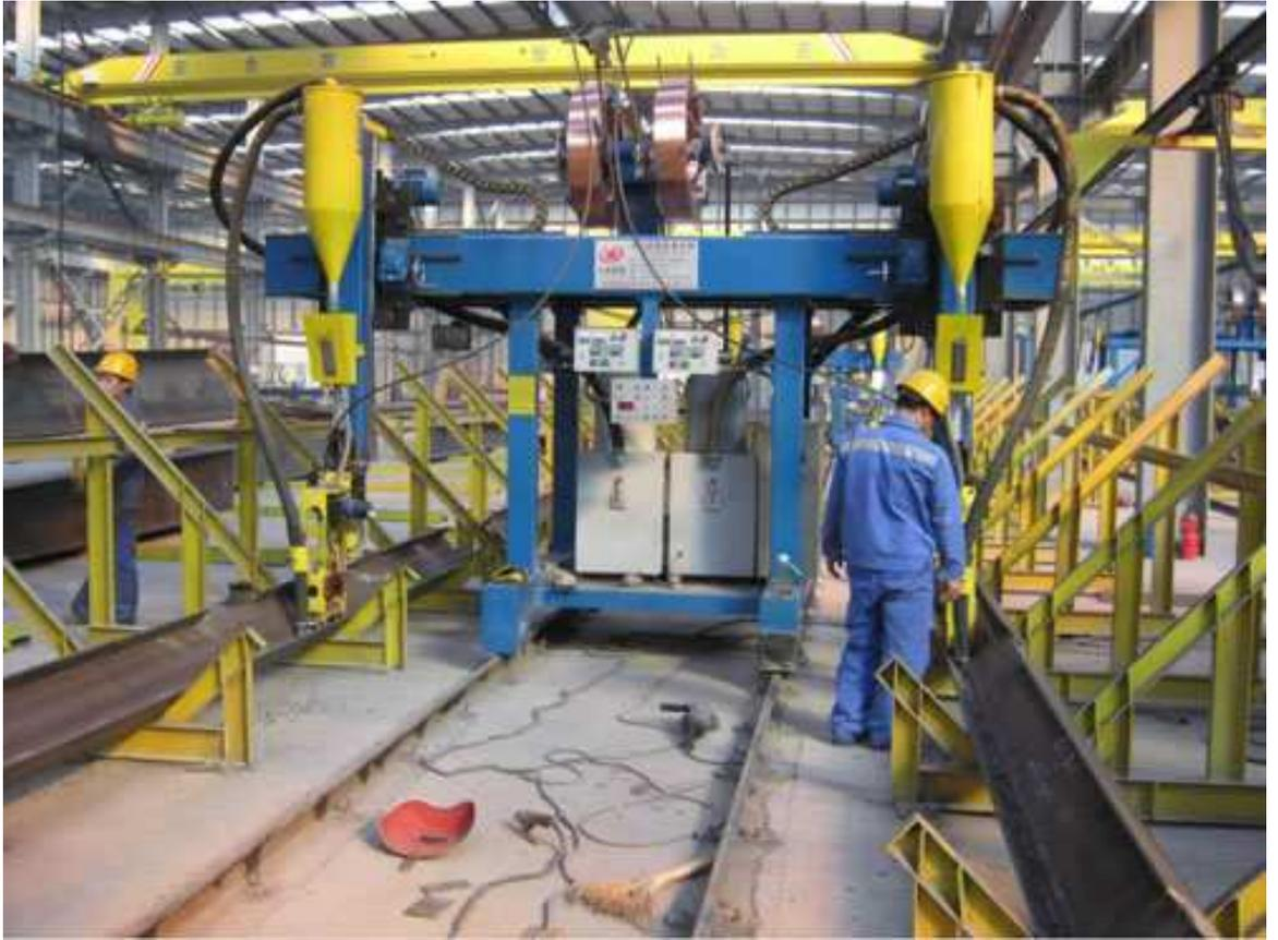
Рис. 3.30 Сварка двумя сварочными головками
