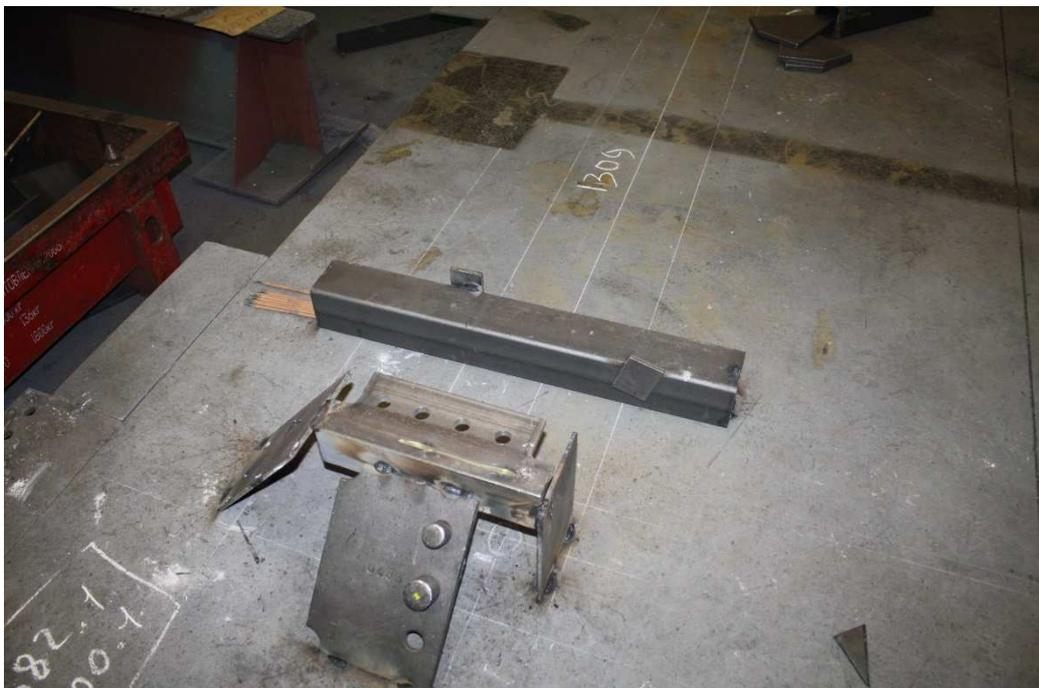
Рис. 6.22 Кондукторные плиты, применяемые для массовой сборки колонн
