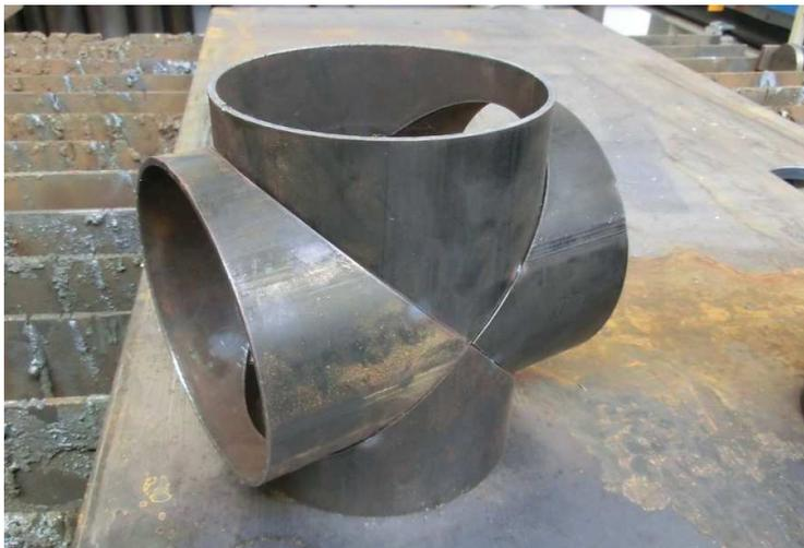
Рис. 3.45 Примыкание нескольких труб друг к другу
