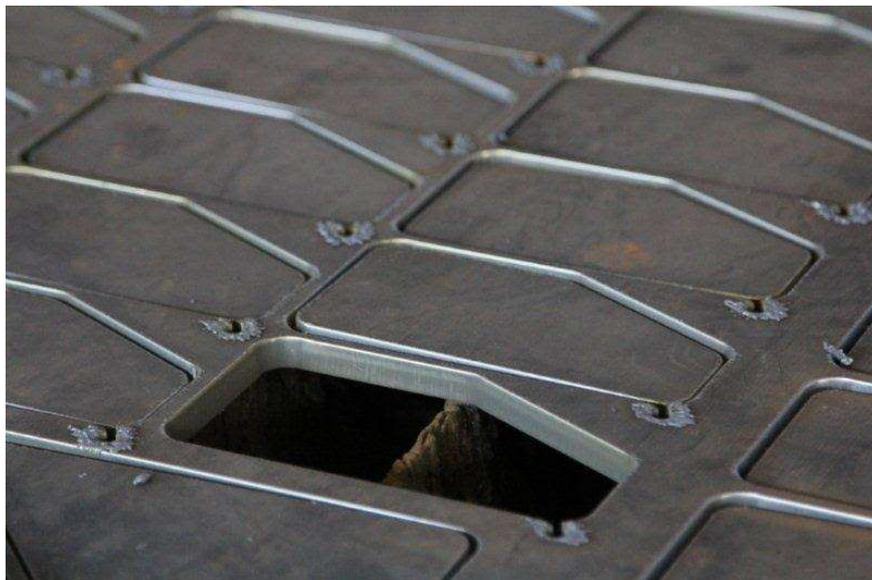
Рис. 3.47 Детали, изготовленные на газорезательной машине с ЧПУ
