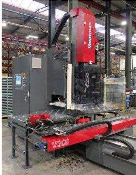
Рис. 3.50 Сверлильный станок для высокоскоростного сверления
