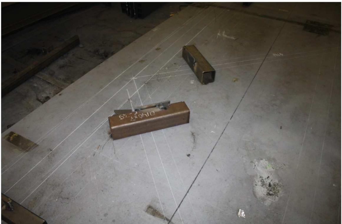
Рис. 6.50 Установка ответных фланцев кондуктора и ограничителей с подложками для раскосов
