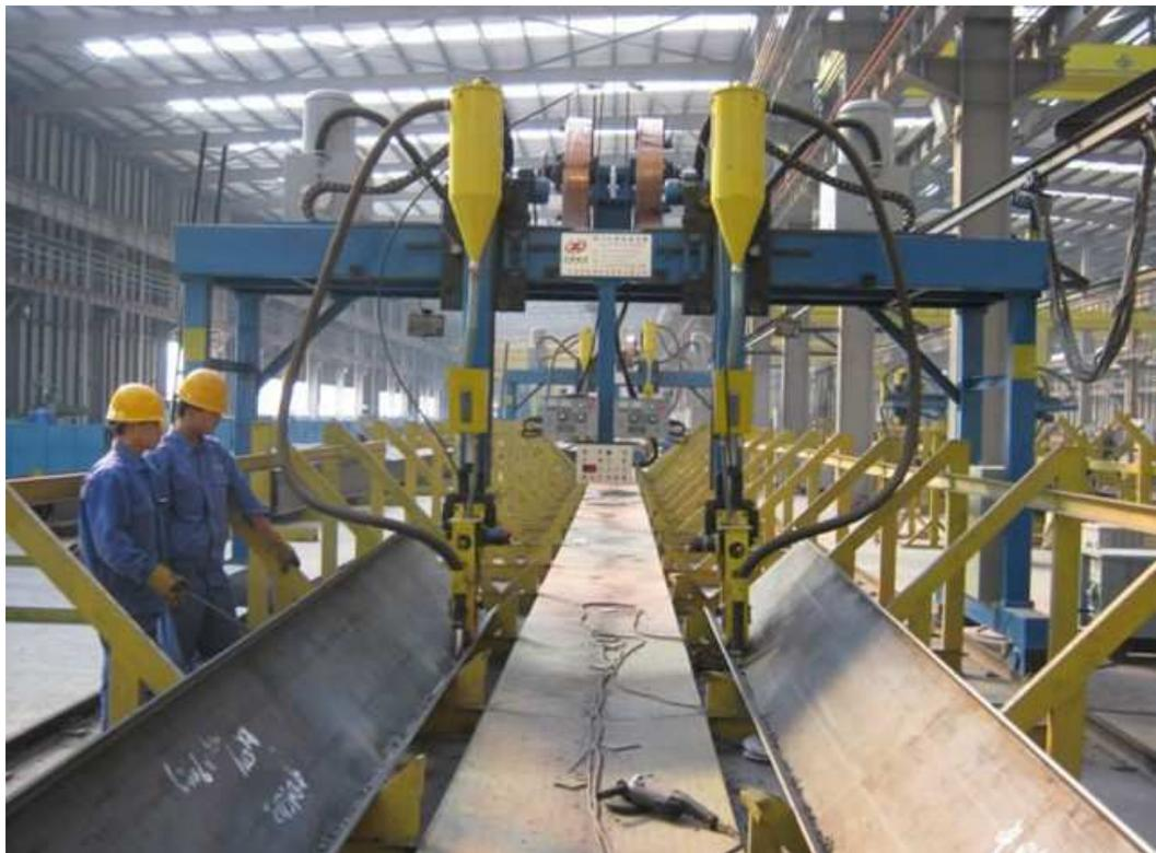
Рис. 3.29 Сварка двумя сварочными головками
