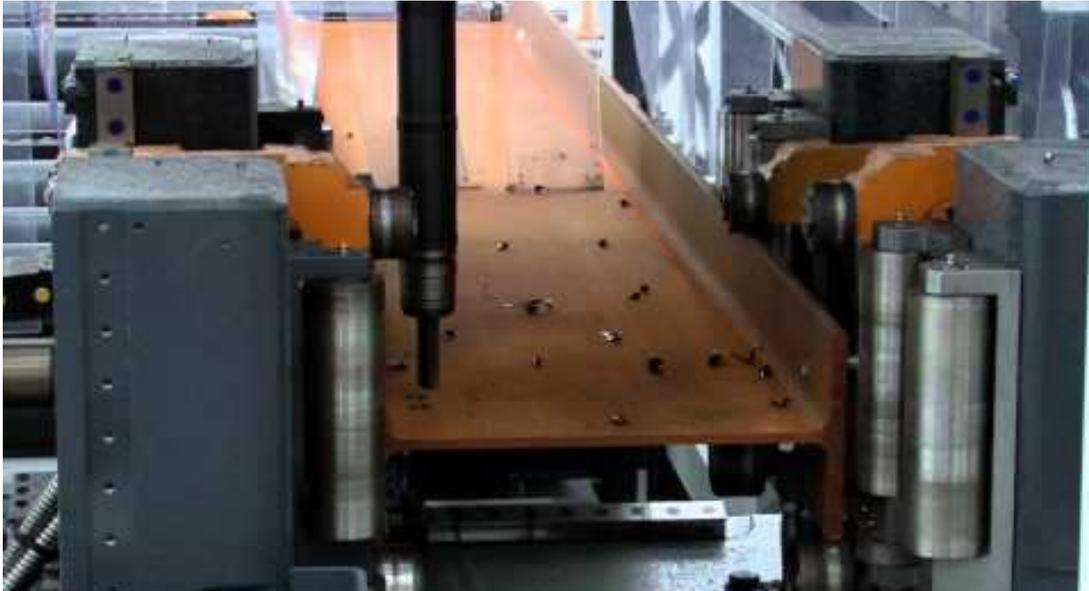
Рис. 3.39 Сверление отверстий
