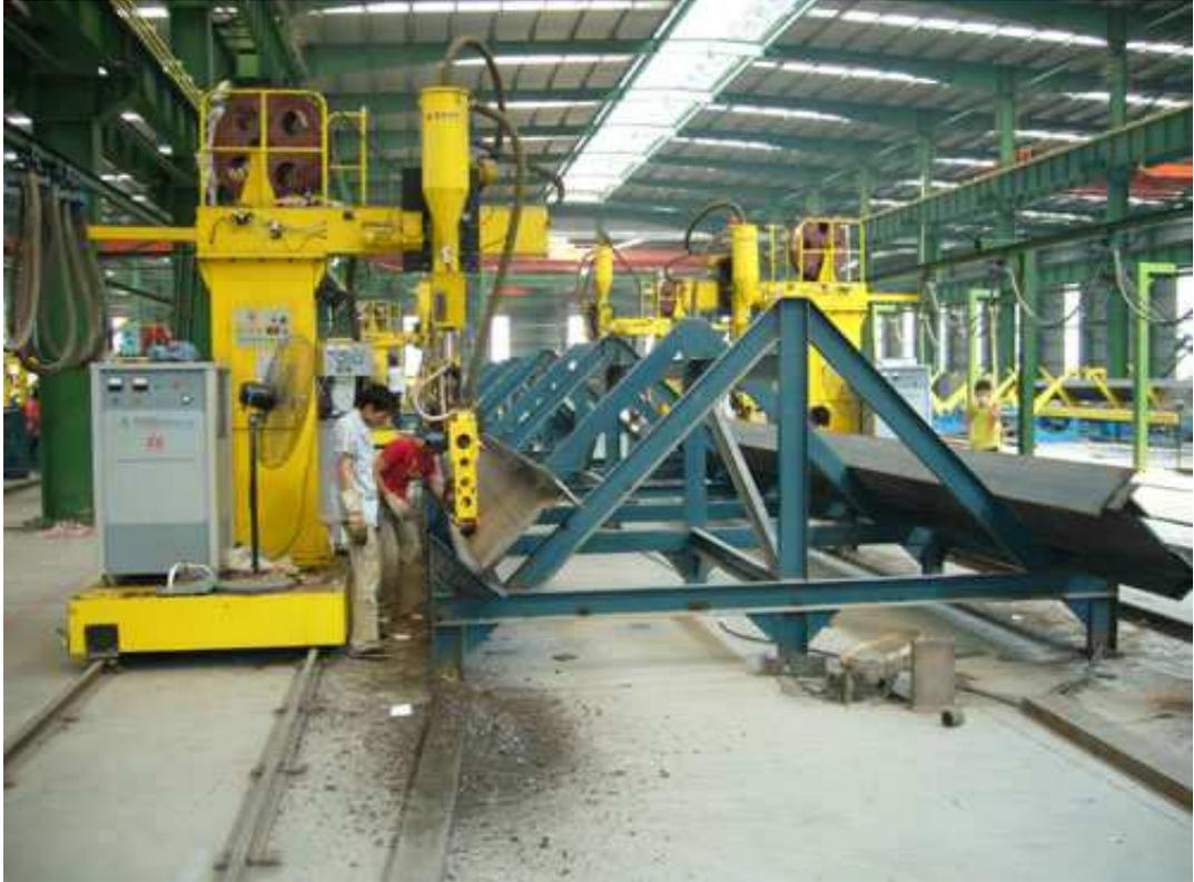
Рис. 3.28 Сварка одной сварочной головкой
