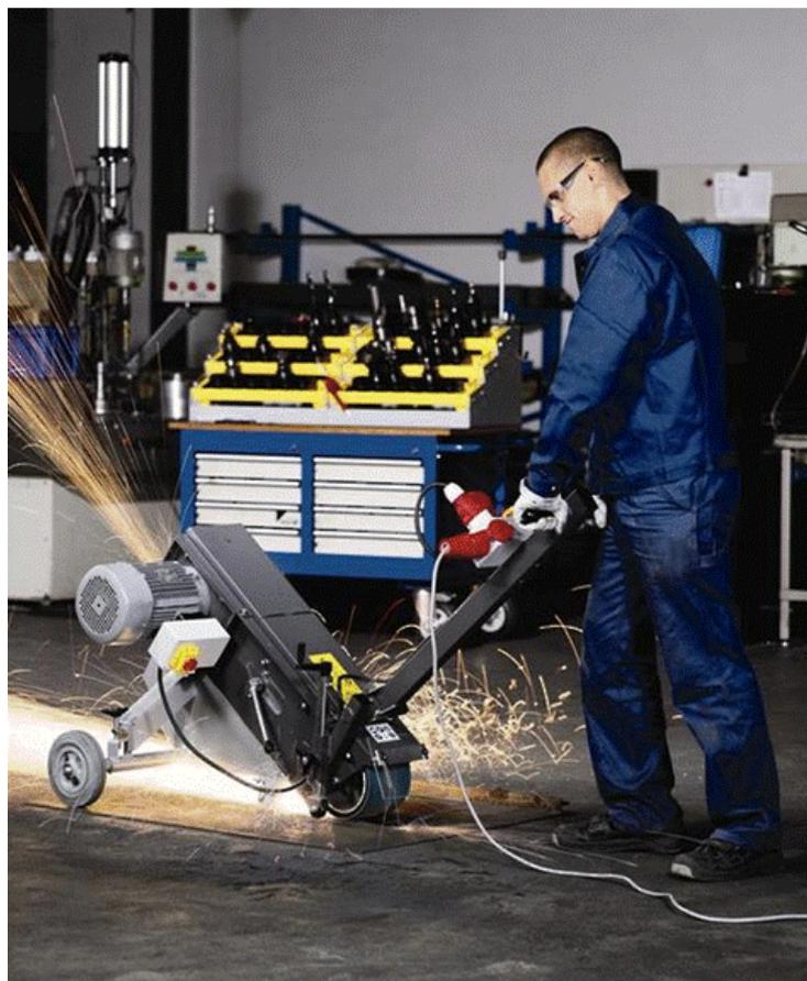
Рис. 3.8 Шлифовальная машина для снятия усиления швов.
