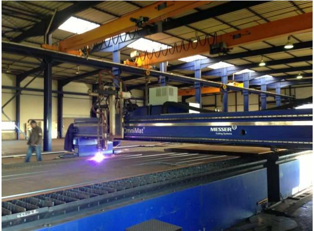
Рис. 3.12 Машины плазменной резки
