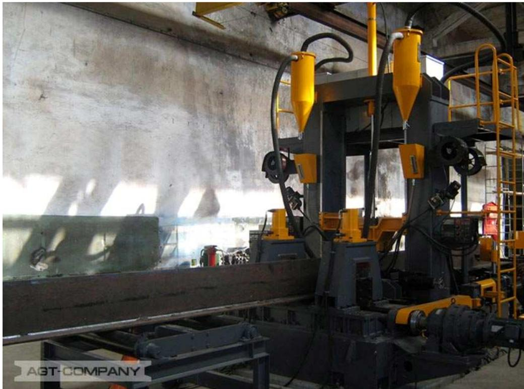
Рис. 3.22 Сборочно-сварочная линия для сборки балок
