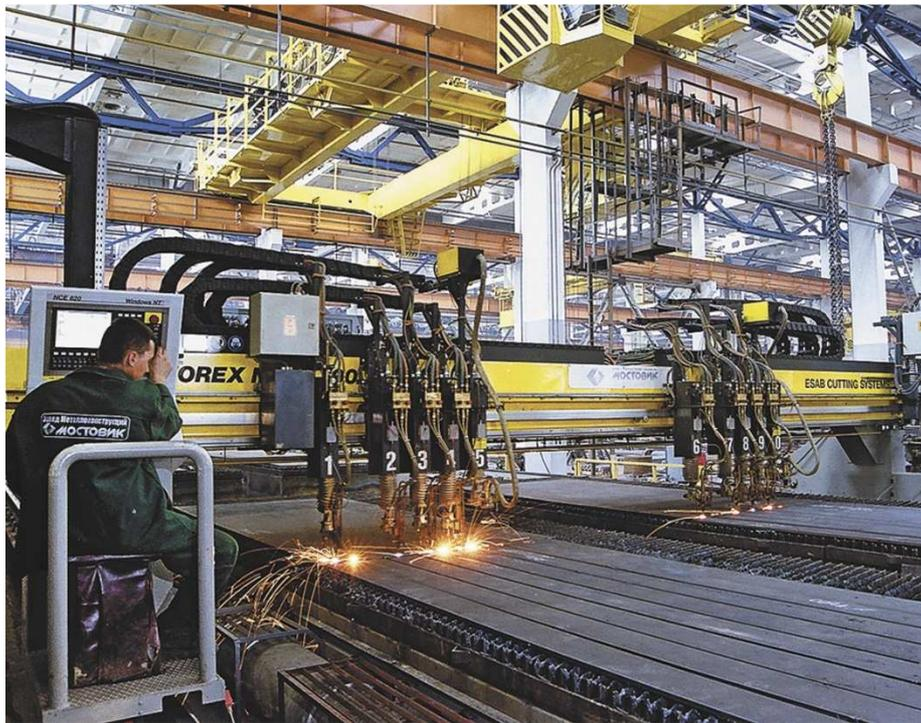
Рис. 3.10 Газорезательная машина с ЧПУ.
