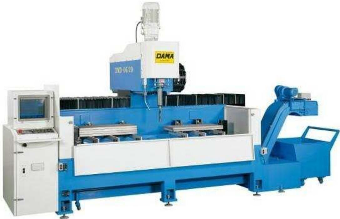
Рис. 3.49 Сверлильный станок с ЧПУ
