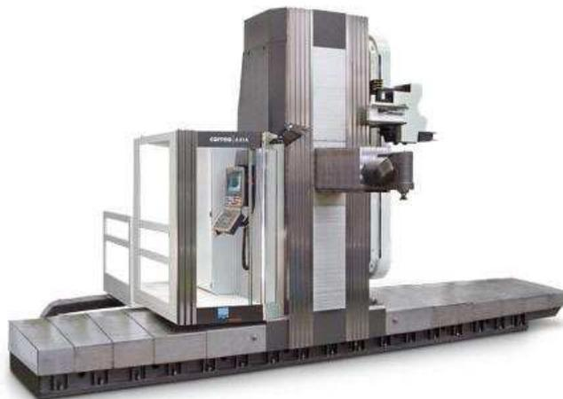
Рис. 3.54 Фрезерно-расточной станок
