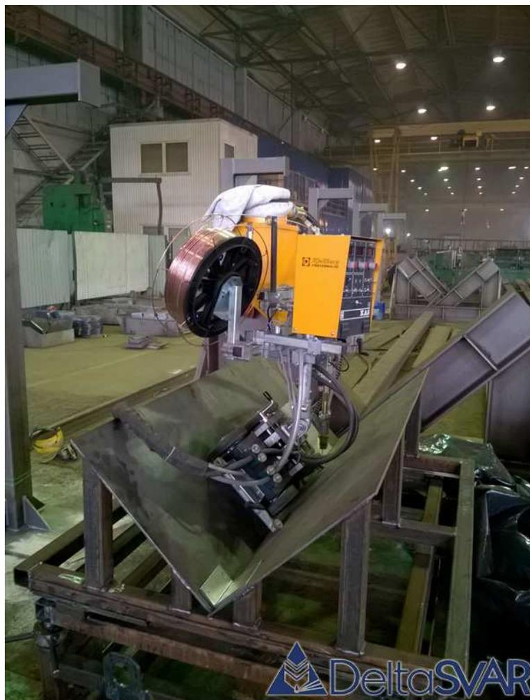
Рис. 3.25 Сварка балки
