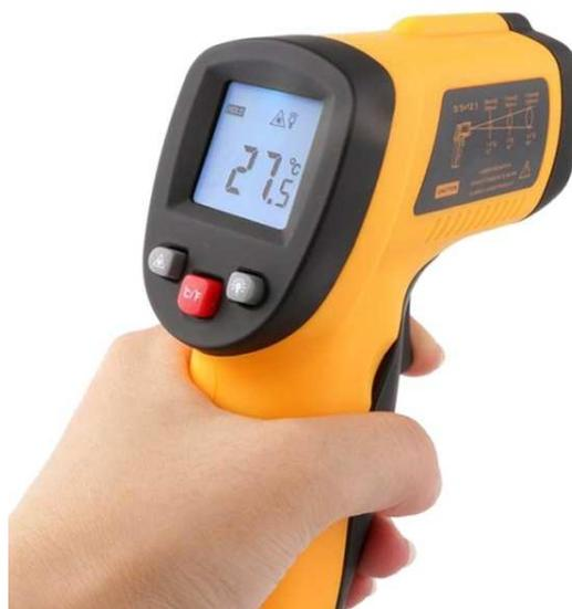
Рис. 4.1 Пирометр для контроля нагрева деталей
