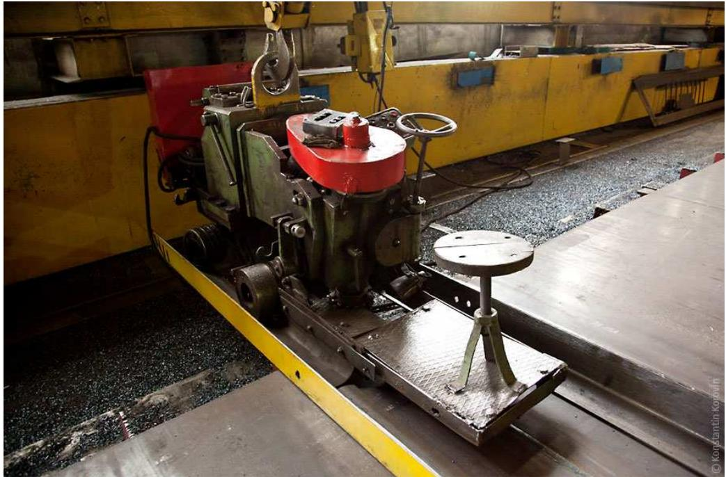
Рис. 3.7 Фрезерные тракторы для снятия усиления швов
