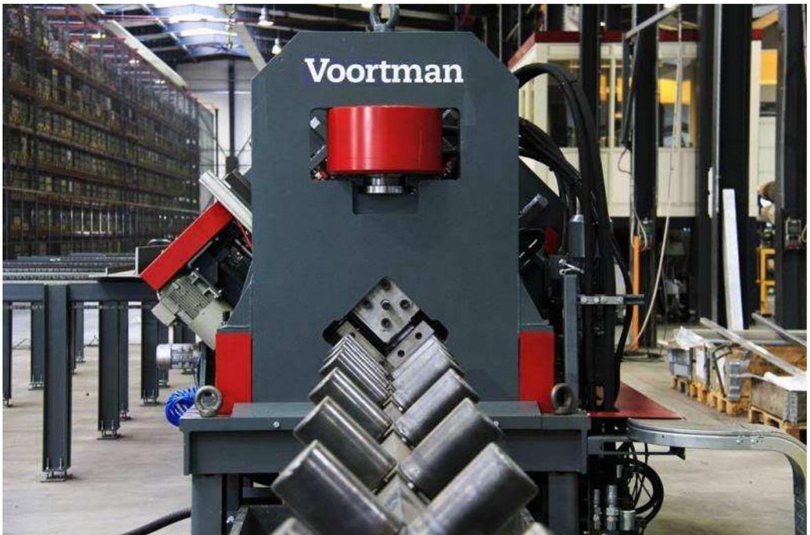
Рис. 3.43 Технологическая линия по обработке уголкового проката
