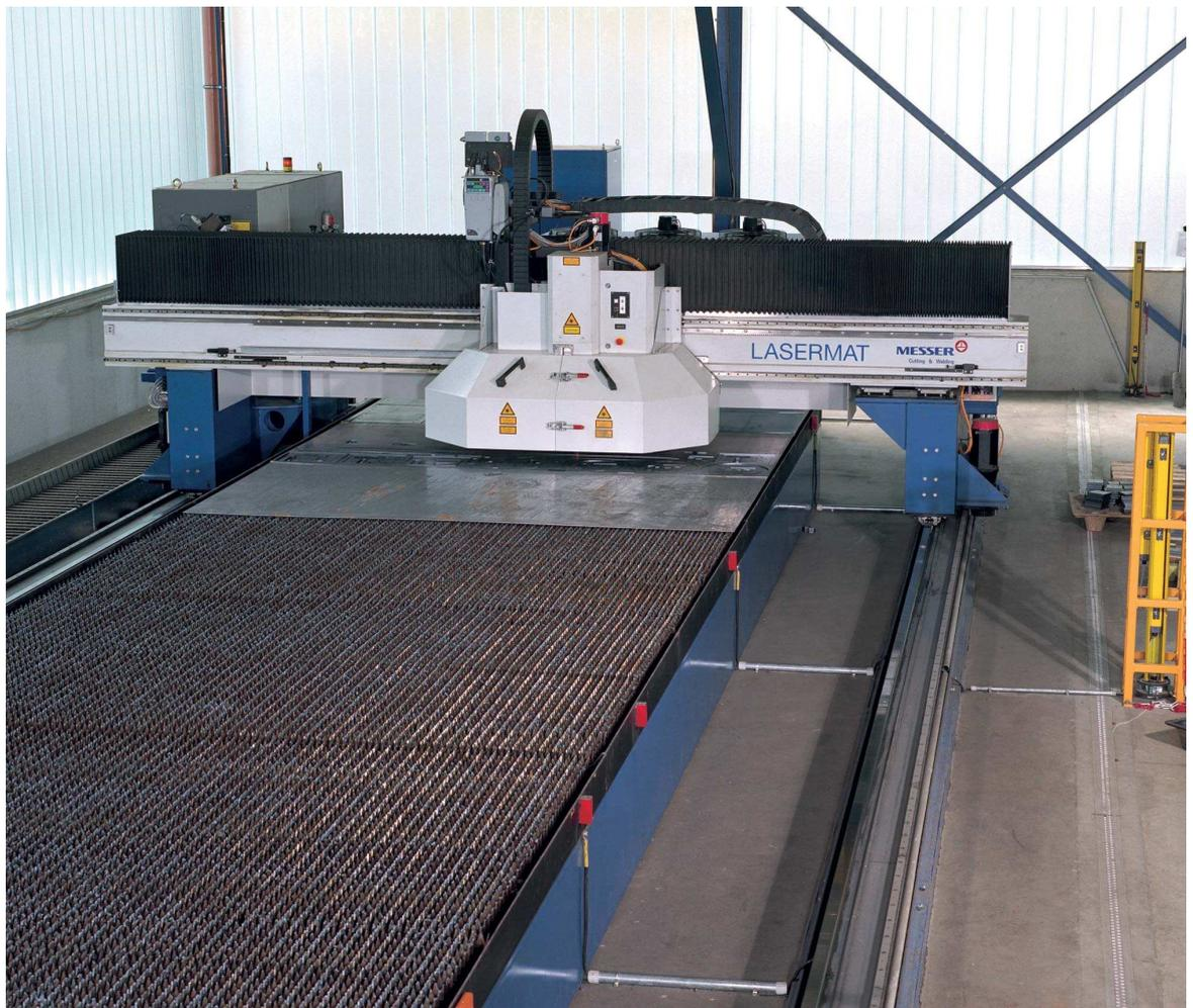
Рис. 3.13 Машина лазерной резки
