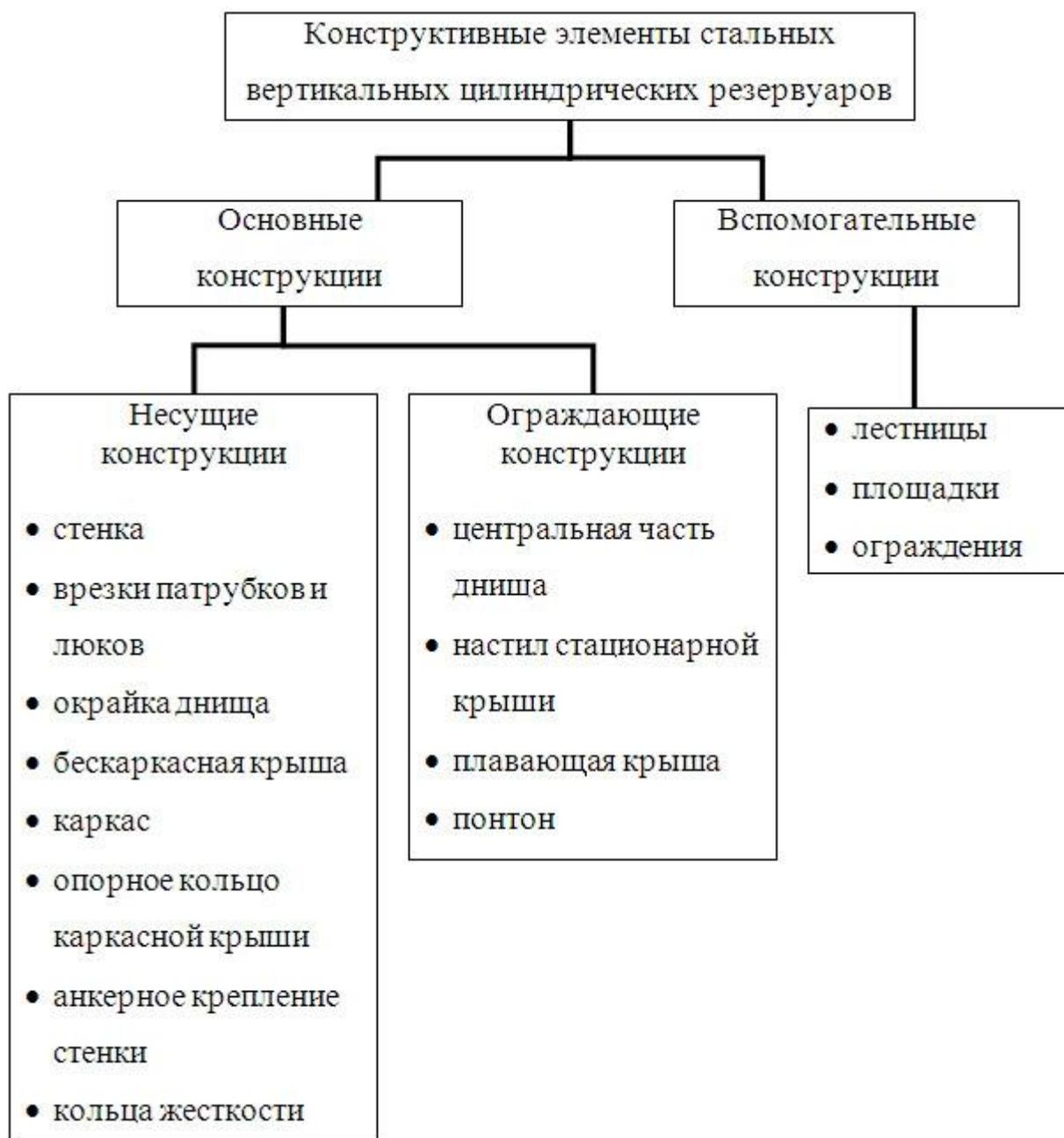
Рис. 3.1 – Диаграмма-классификация элементов ВЦР
