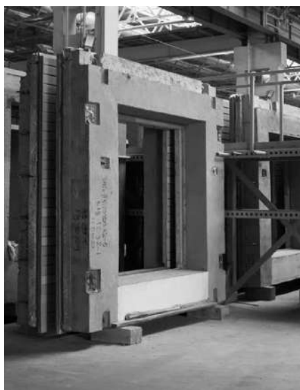
Рис. 4. Фасадная панель под витражное остекление. Завод «KM PRECAST».
