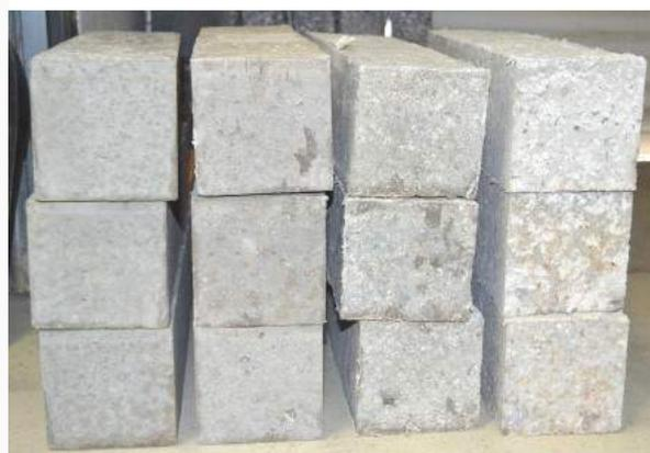
Рис. 3. Образцы призматических балок до эксперимента
