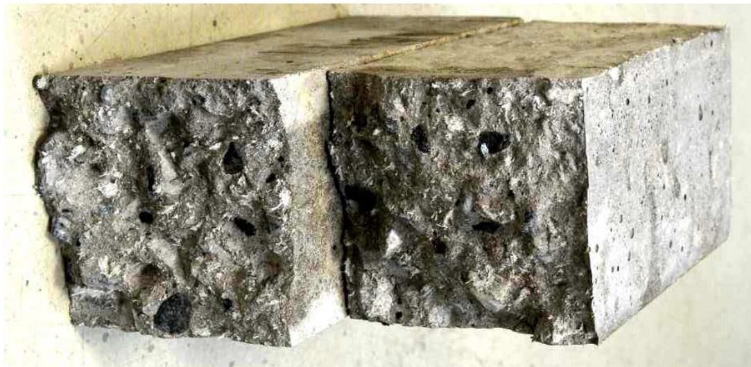
Рис. 5. Агрегация хризотилowych волокон («ежи») в образце с 5%-ным армированием фибробетона.
