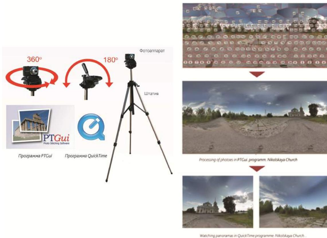
Рис. 4. Инструмент создания сферической панорамы(слева), создание сферической панорамы в окне программы (справа)
