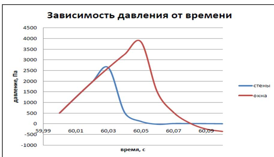
Рис. 4. Изменение давления при поджиге на 60 секунде, и срабатывании различных ПК
