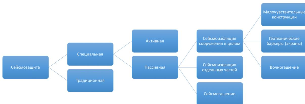
Рис. 1. Классификация систем сейсмозащиты по принципу их работы
