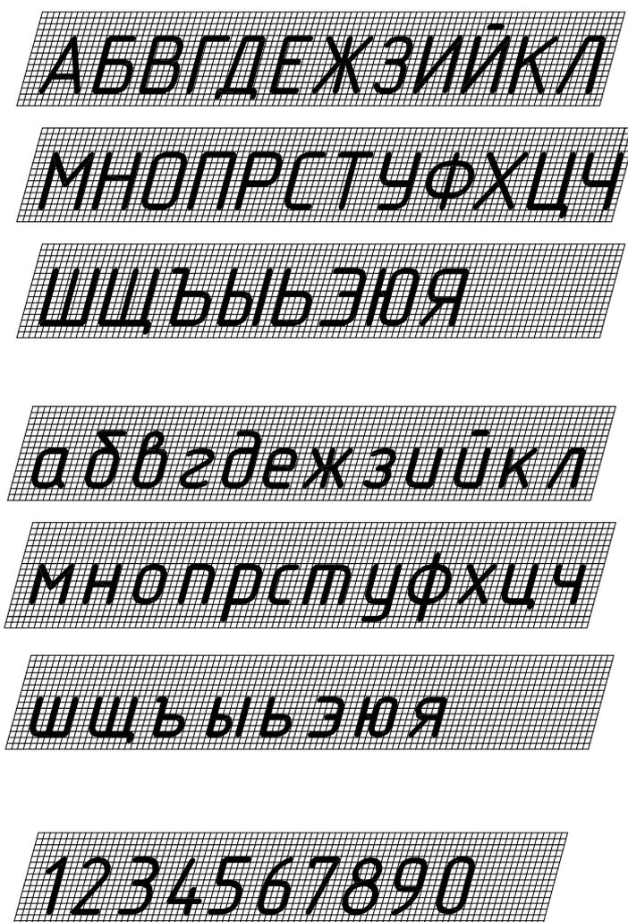
Рис.6. Шрифт чертежный типа *B* с наклоном
