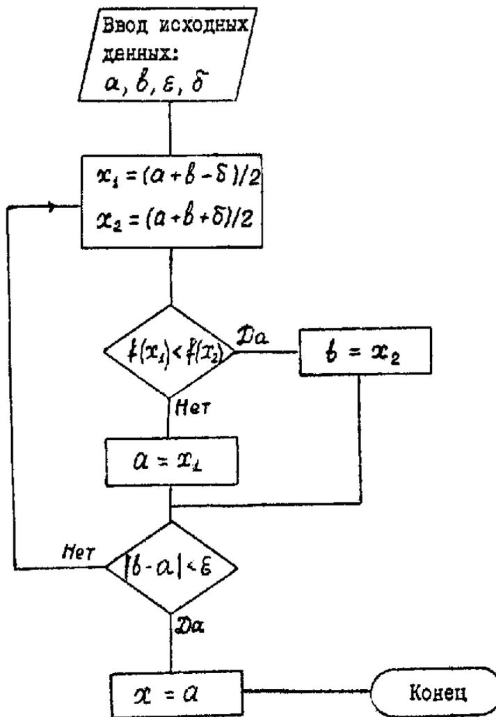
Рис. 13. Блок-схема метода дихотомии
