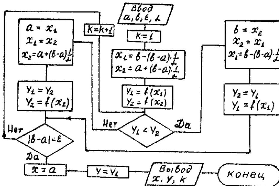
Рис. 15. Блок-схема метода золотого сечения
