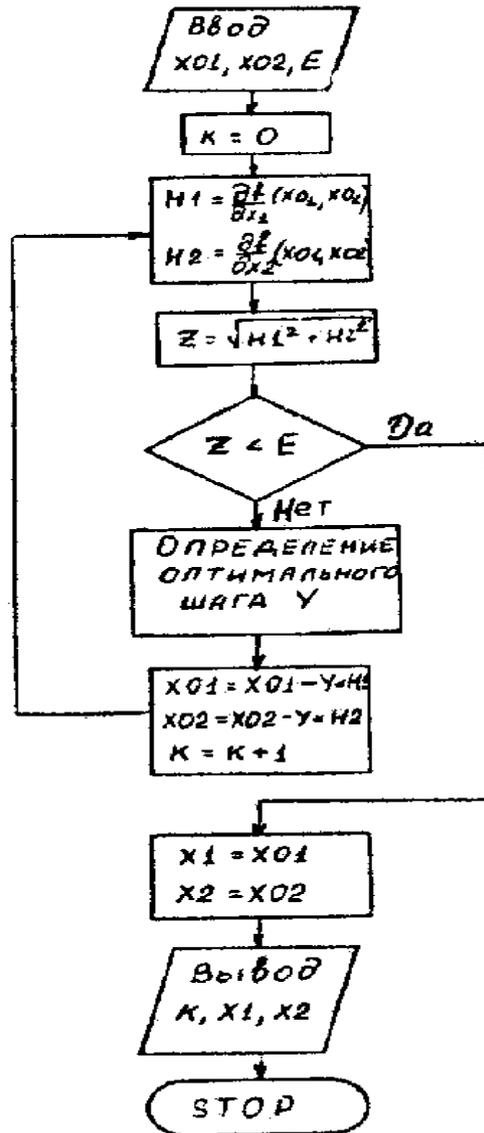
Рис. 22. Блок-схема метода наискорейшего спуска
