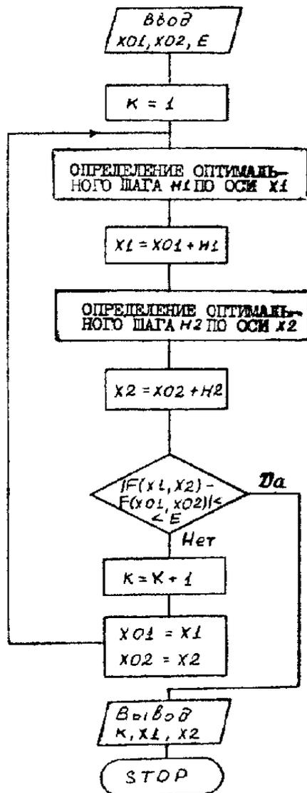
Рис. 21. Блок-схема метода покоординатного спуска
