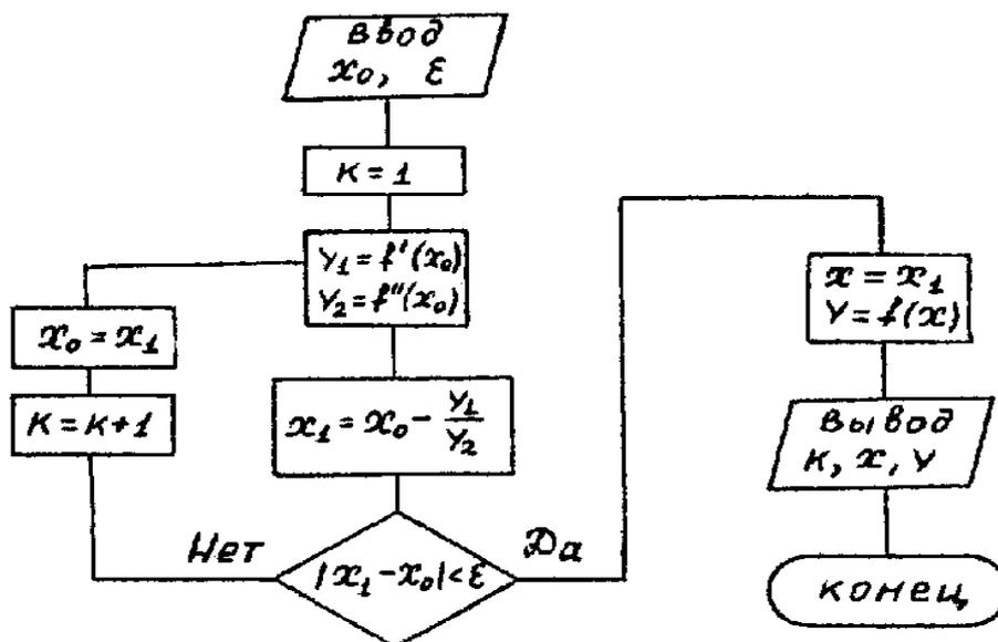
Рис. 16. Блок-схема метода Ньютона
