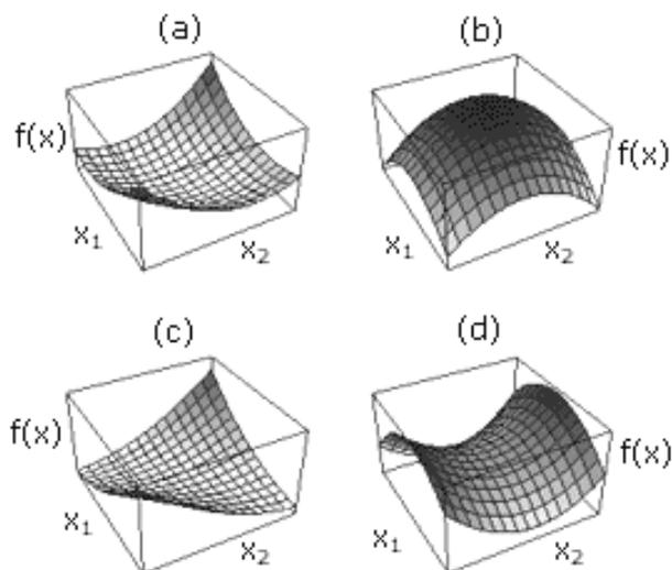
Рис. 20. Квадратичные формы для положительно-определенной, отрицательно-определенной, положительно-полуопределенной, неопределенной матрицы
