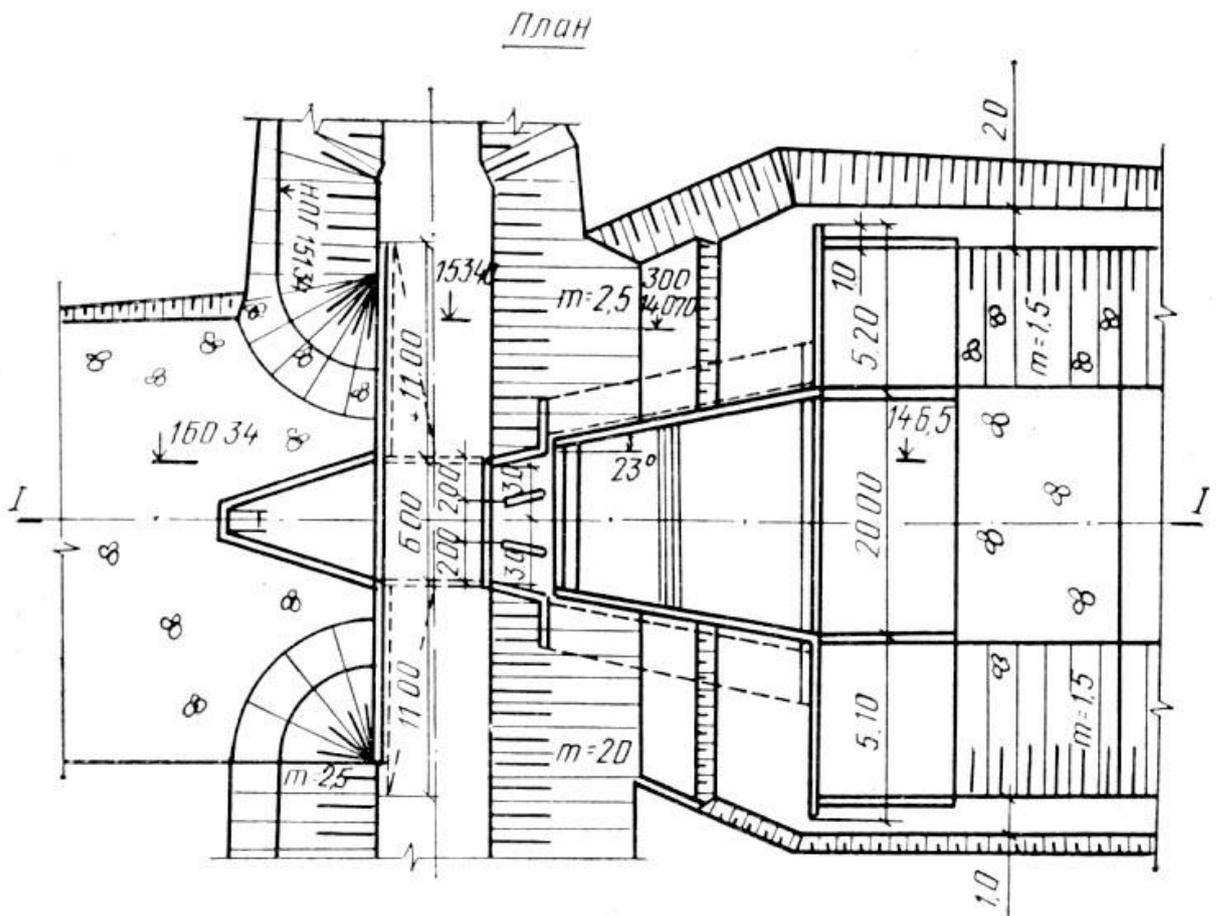
Рис. Г.5. Открытый береговой водосброс с полигональным водосливным оголовком
