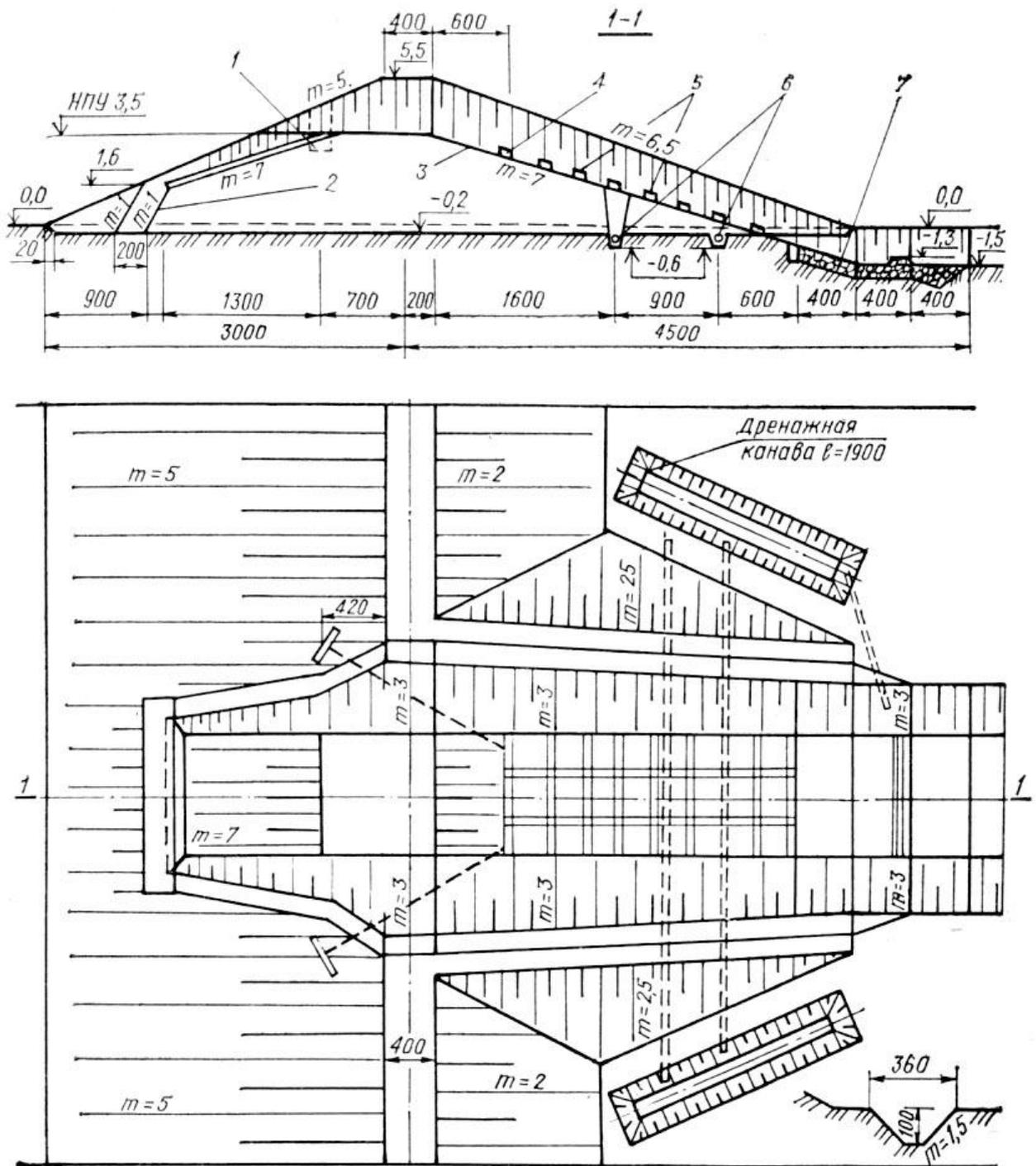
Рис. Г.6. Грунтовая водосливная плотина с асфальтобетонным покрытием
