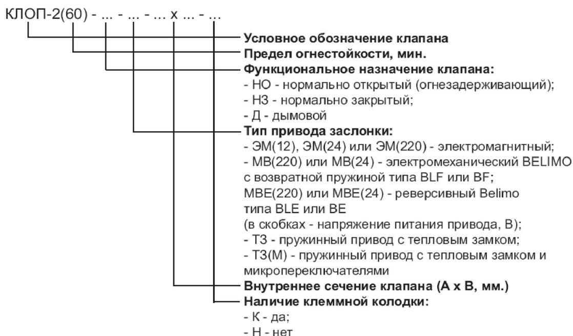
**КЛОП-2(60)-Д-ЭМ(220)-400x400-К** – клапан КЛОП-2 с пределом огнестойкости 60 мин., дымовой, с электромагнитным приводом 220 В. с размером внутреннего сечения 400x400 мм., с клеммной колодкой.
