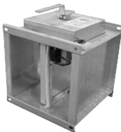
Рис. 4. Общий вид огнезадерживающего клапана с открытой заслонкой, электромагнитным приводом, установленным внутри, и рукояткой для ручного взведения
