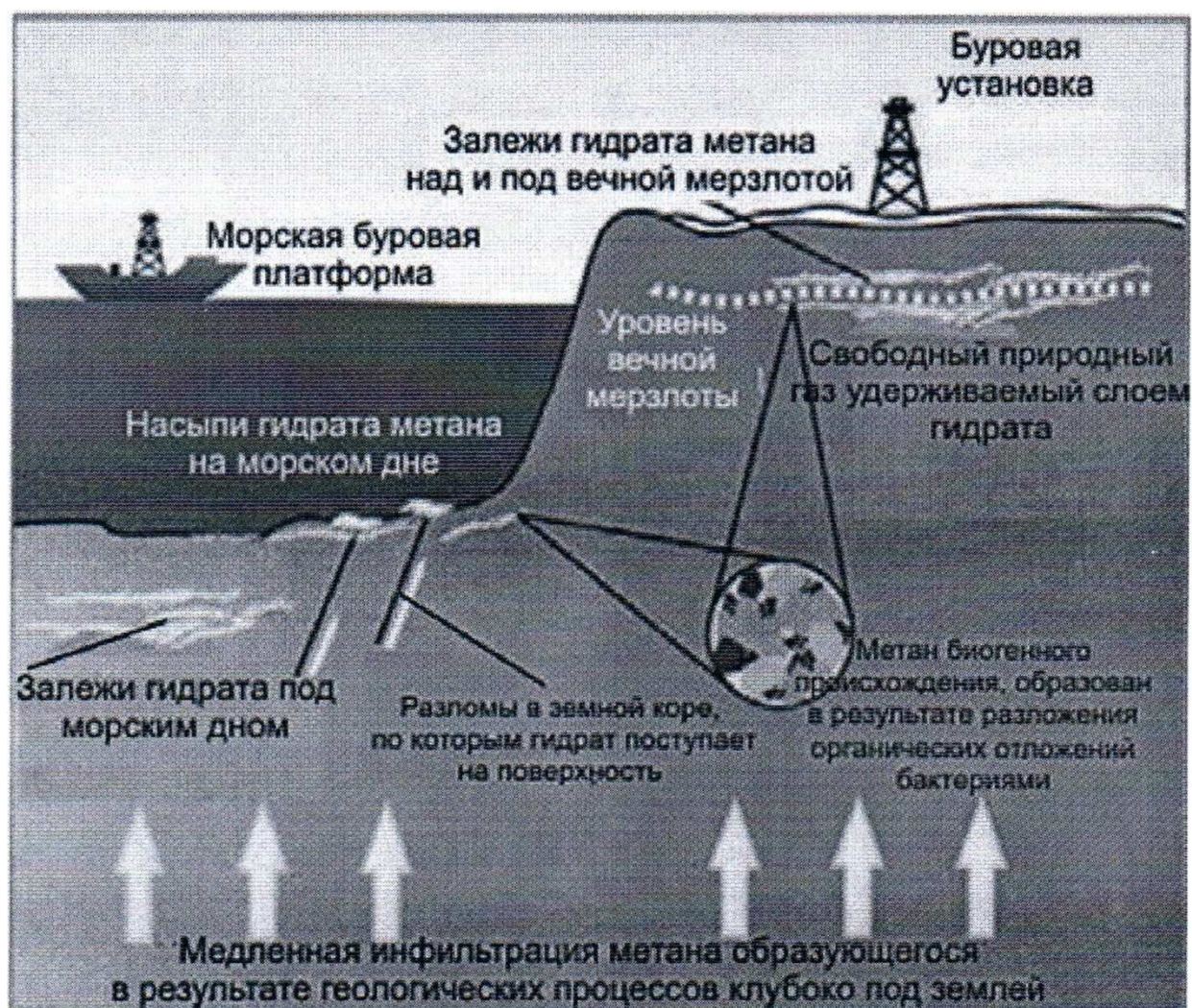
Рисунок 3. Схема образования гидрата метана
