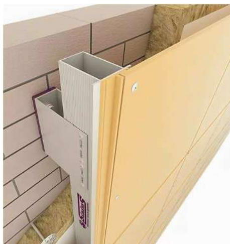
Рисунок 3 – Подсистема для вентфасада из фиброцементной плиты.
