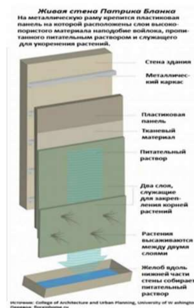
Рисунок 4 - Конструкция зелёной мат-стены Патрика Бланка
