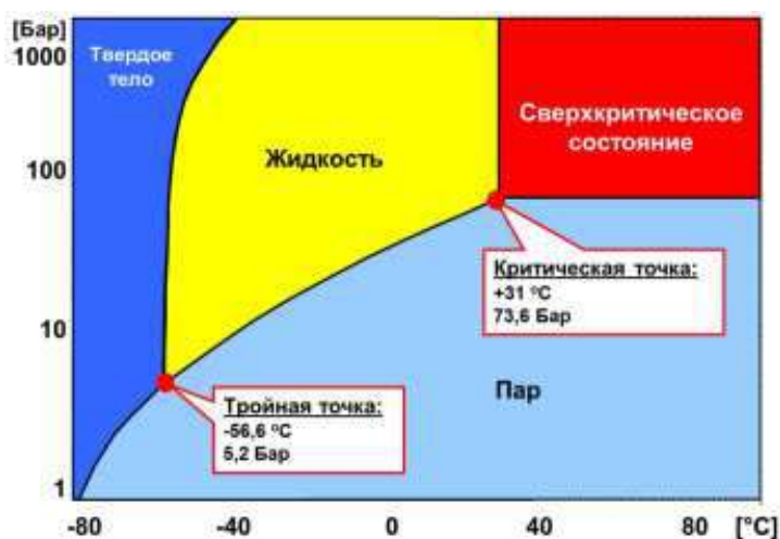
Рисунок 2 – Фазовая диаграмма хладагента диоксида углерода ( \text{CO}_2 )
