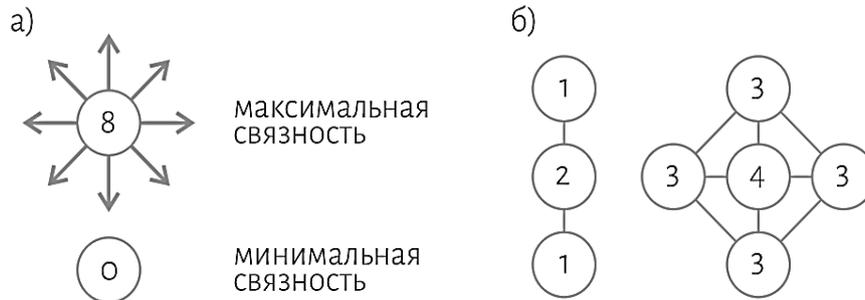
Рис. 1. Ортогональная связанность с ортогональными и диагональными связями
