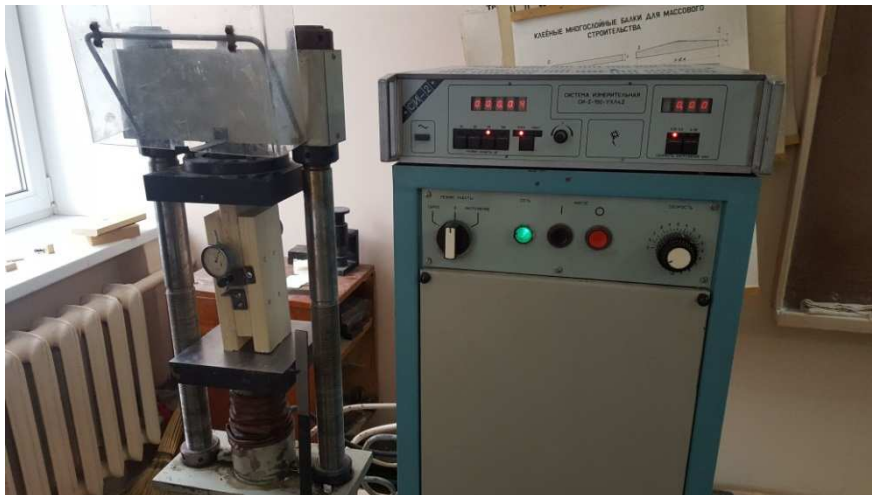
Рисунок 8 – Общий вид установки испытания гвоздевого соединения на гидравлическом прессе
