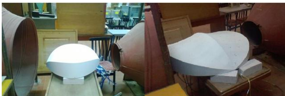
Рис.1. Макеты криволинейных сооружений, установленные в аэродинамической трубе
