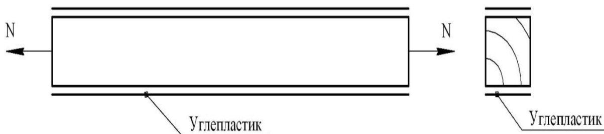
Рис.1. Расчетная схема усиления растянутого деревянного элемента углепластиком
