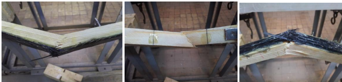
Рис. 4. Разрушение деревянных образцов усиленных углеродным волокном
