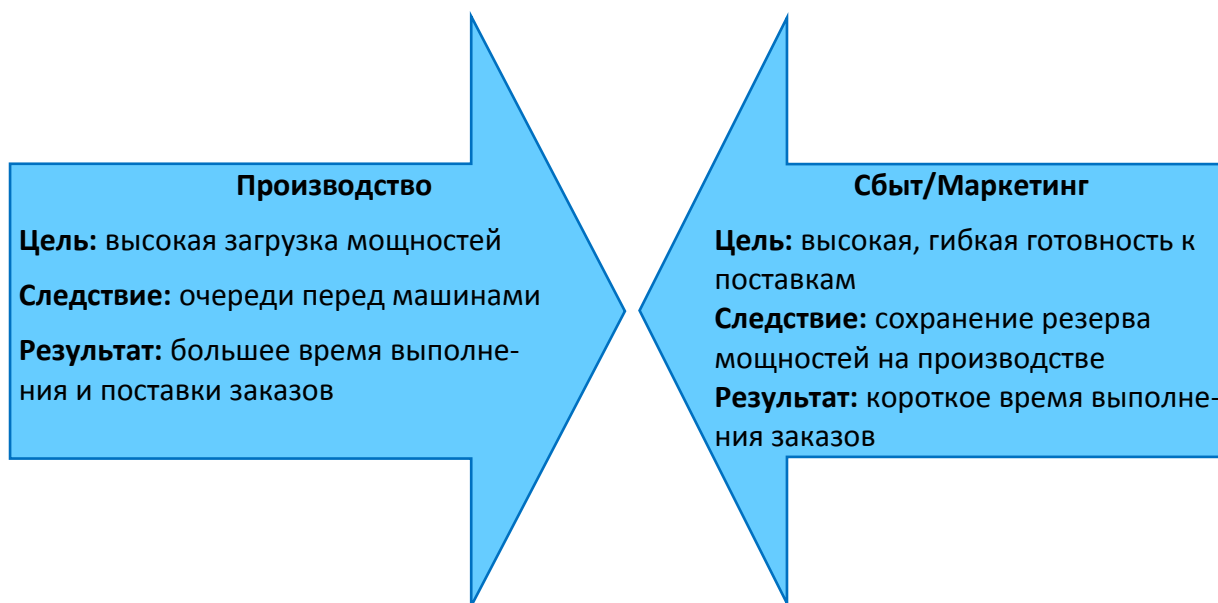
Рис. 2.11. Конкурирующие цели планирования производства, дилемма «планирования процесса производства»
