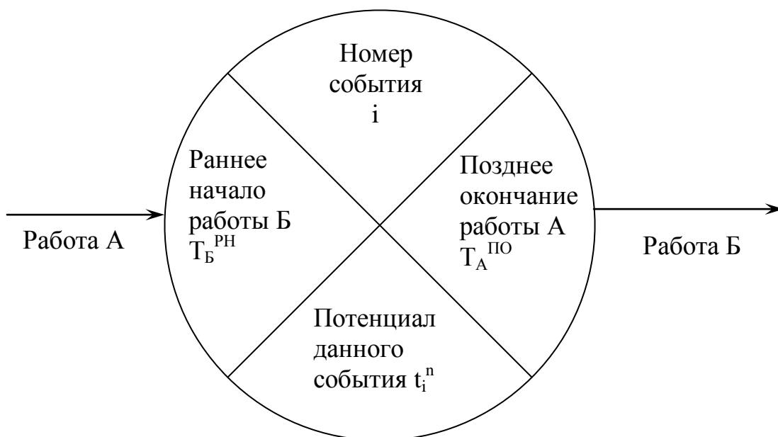
Рис. 4.17. Содержание секторов событий при расчёте методом потенциалов, применяемым в строительной практике
