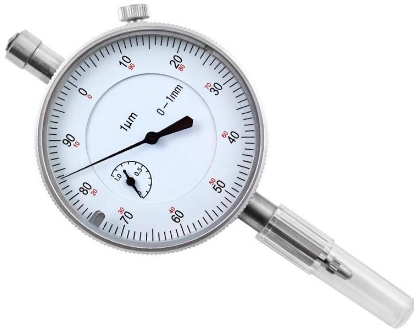
Рисунок 2 – Общий вид индикатора часового типа ИЧ10.
