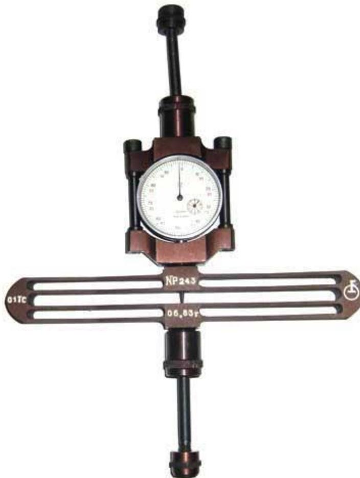
Рисунок 4 – Общий вид динамометра.
