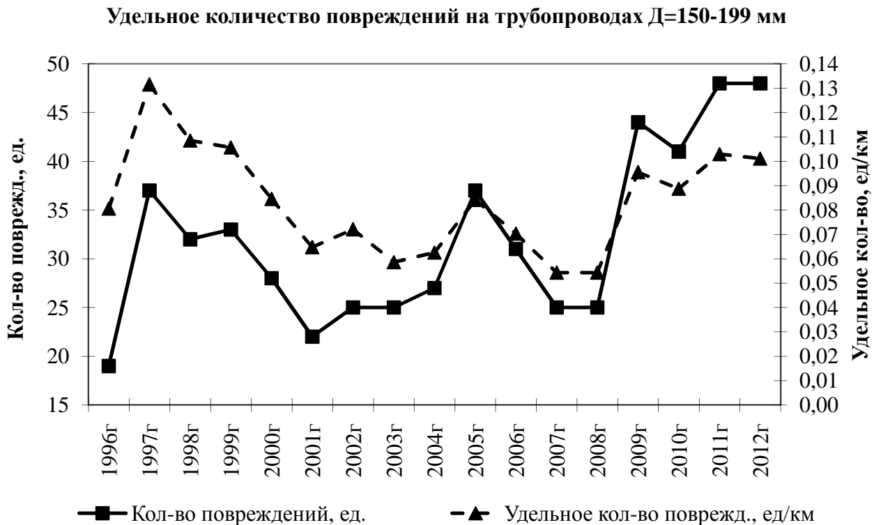
Рис.2.15 Динамика изменения количества повреждений за период с 1996 г по 2012 г. в зависимости от диаметра трубопровода в сравнении с удельным количеством повреждений на трубопроводах Д=150-199 мм
