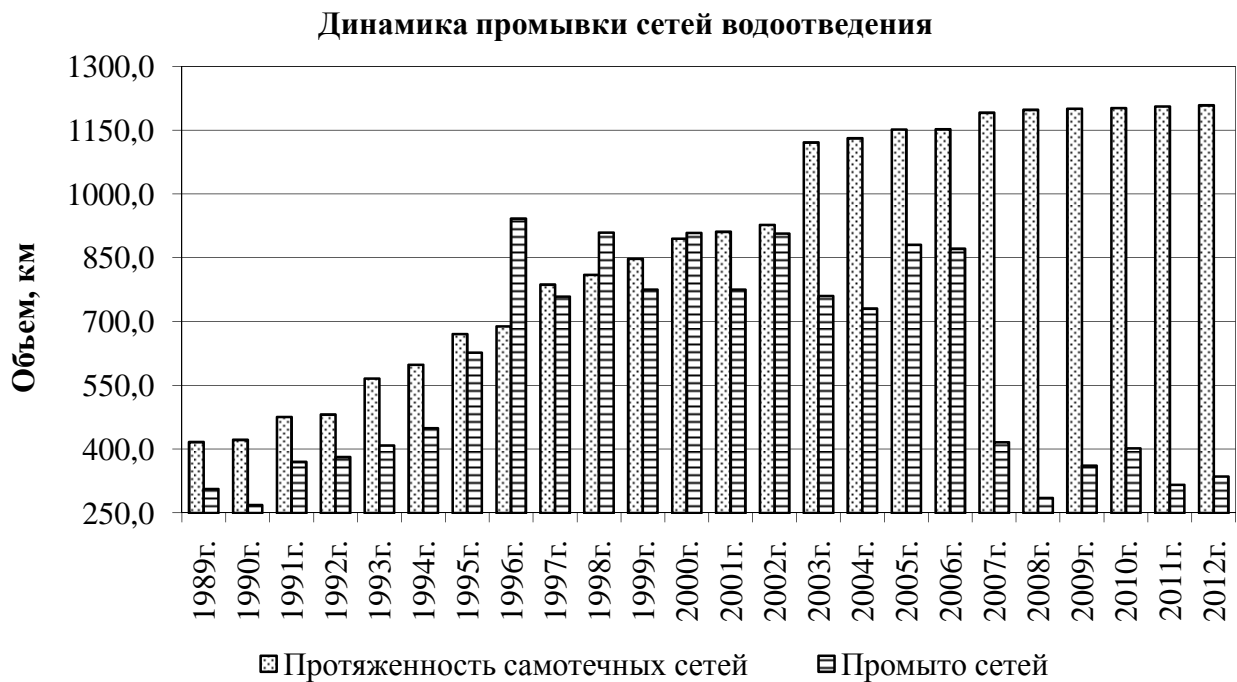
Рис. 3.7 Динамика промывки сетей водоотведения за период с 1989 по 2012 г.г
