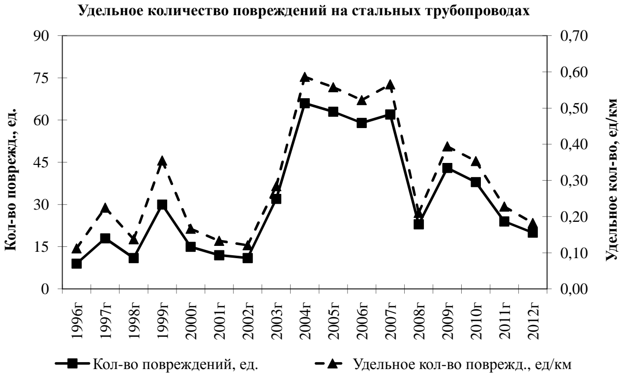
Рис.2.10 Динамика изменения количества повреждений за период с 1996 г по 2012 г. в зависимости от диаметра трубопровода в сравнении с удельным количеством повреждений для стальных трубопроводов
