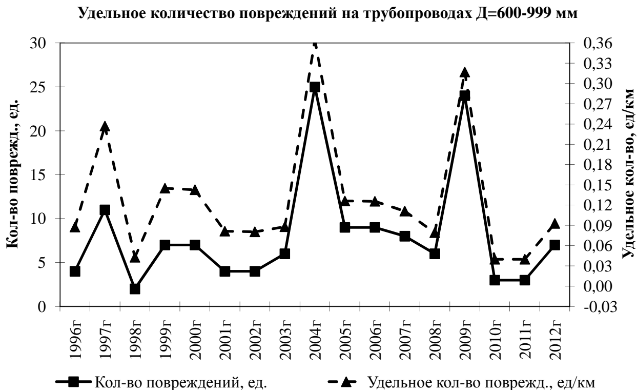
Рис.2.18 Динамика изменения количества повреждений за период с 1996 г по 2012 г. в зависимости от диаметра трубопровода в сравнении с удельным количеством повреждений на трубопроводах Д=600-999 мм
