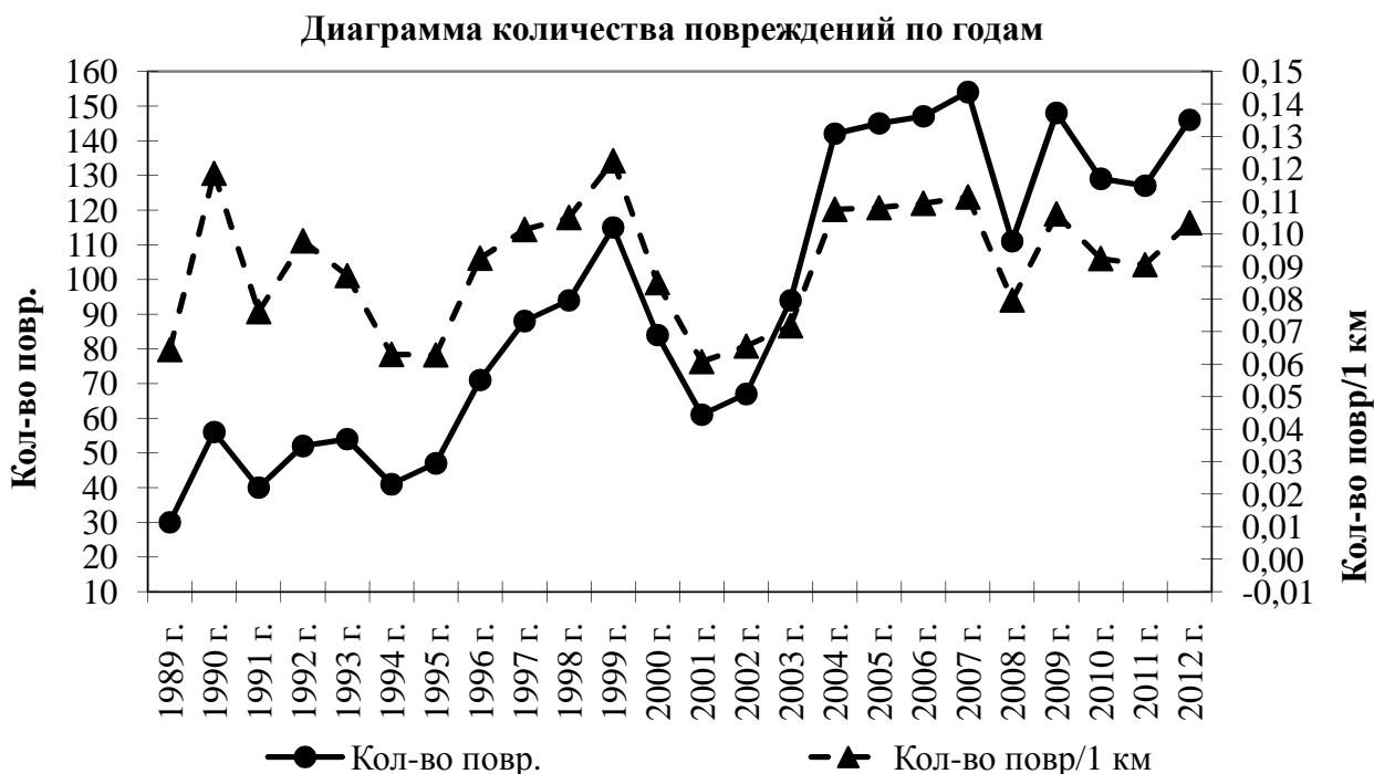
Рис. 2.1 Динамика изменения количества повреждений в сопоставлении с удельным количеством повреждений.
