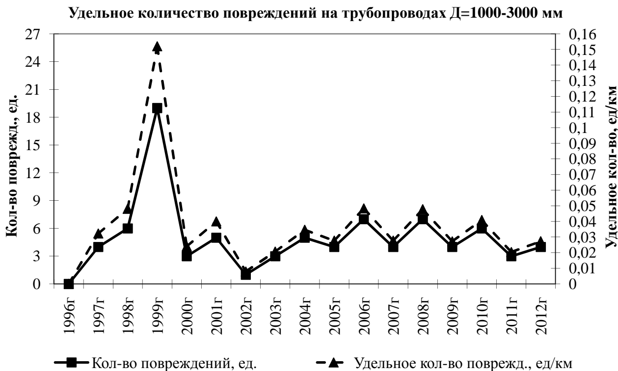
Рис.2.19 Динамика изменения количества повреждений за период с 1996 г по 2012 г. в зависимости от диаметра трубопровода в сравнении с удельным количеством повреждений на трубопроводах Д=1000-3000 мм
