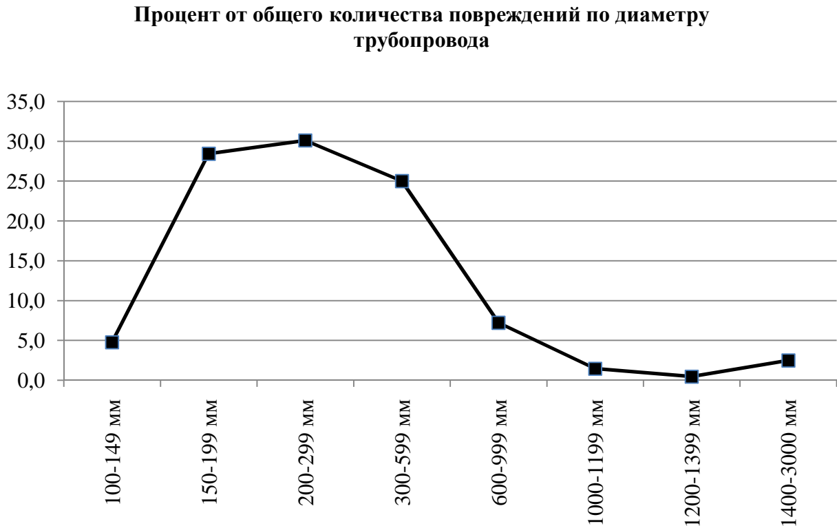
Рис.2.13 Средний процент повреждений за период с 1996 г. по 2012 г. на сетях различных диаметров.
