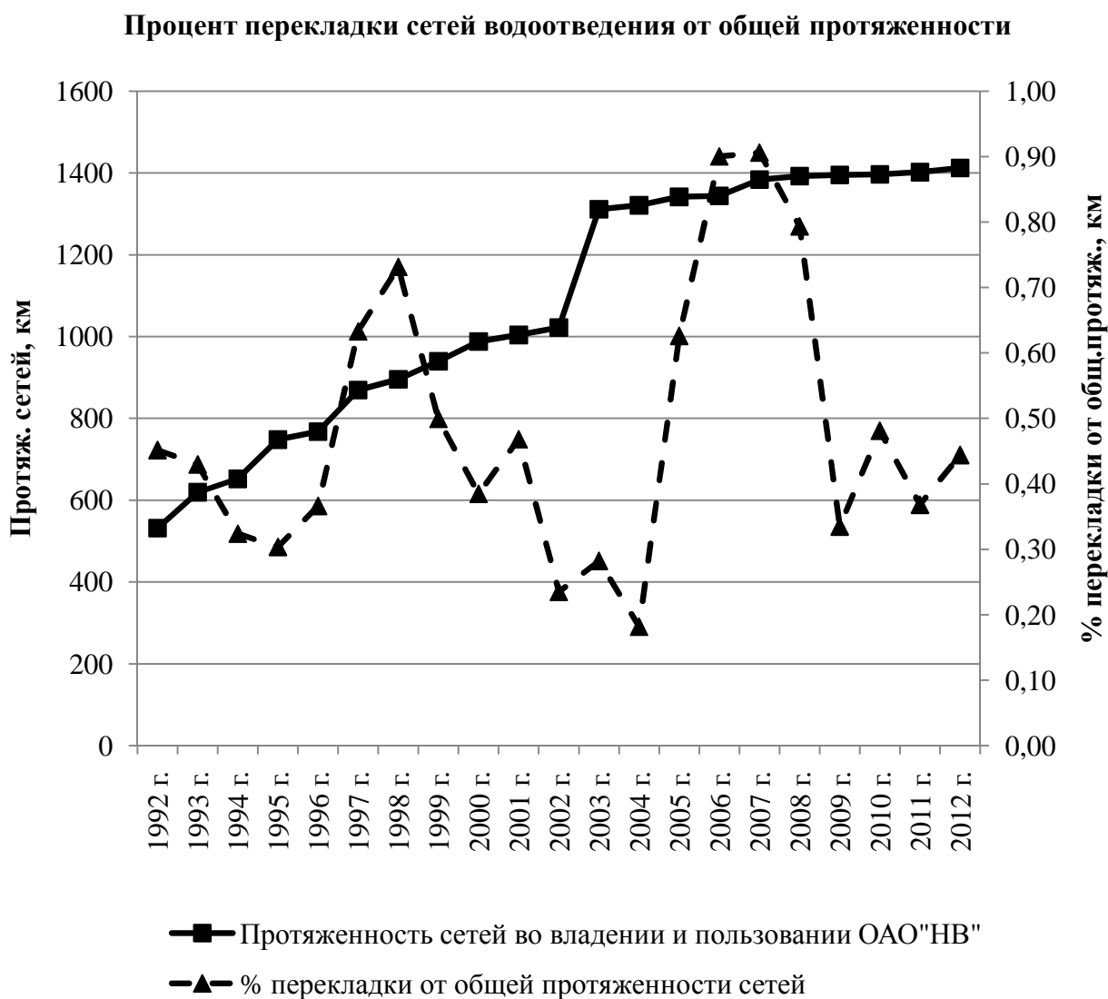
Рис. 3.24 Динамика изменения процента перекладки сетей водоотведения от общей протяженности за период с 1992 по 2012 г.г.
