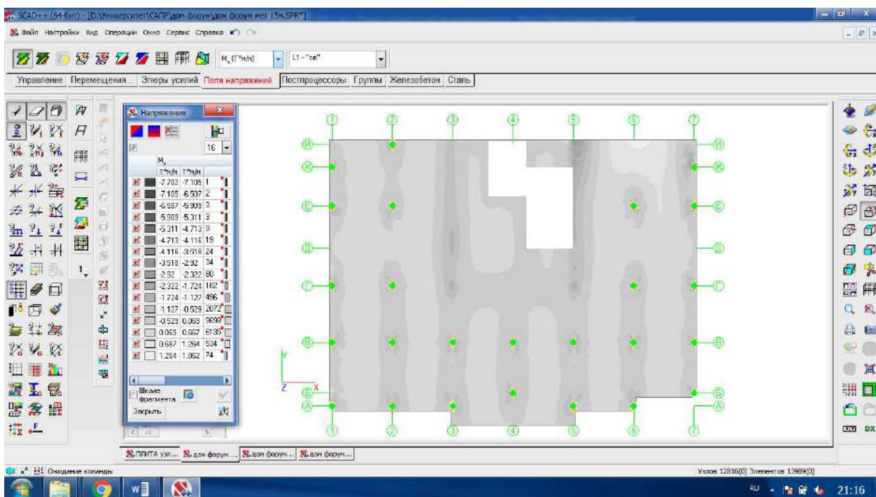
Рис. П.7. Поля напряжений M_x от собственного веса при наличии жестких тел на участках пересечения колонн и перекрытий
