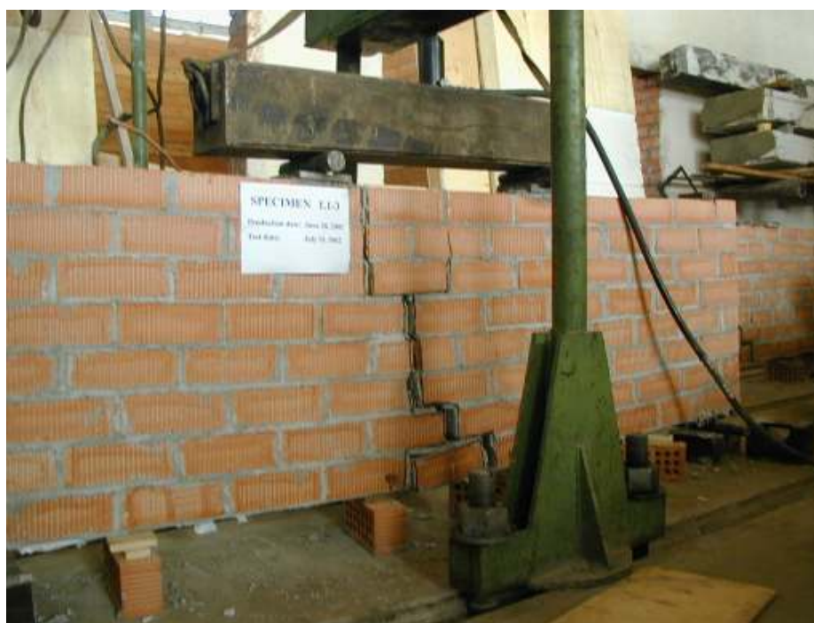
Рис. 3.28. Фотография разрушения конструкции
