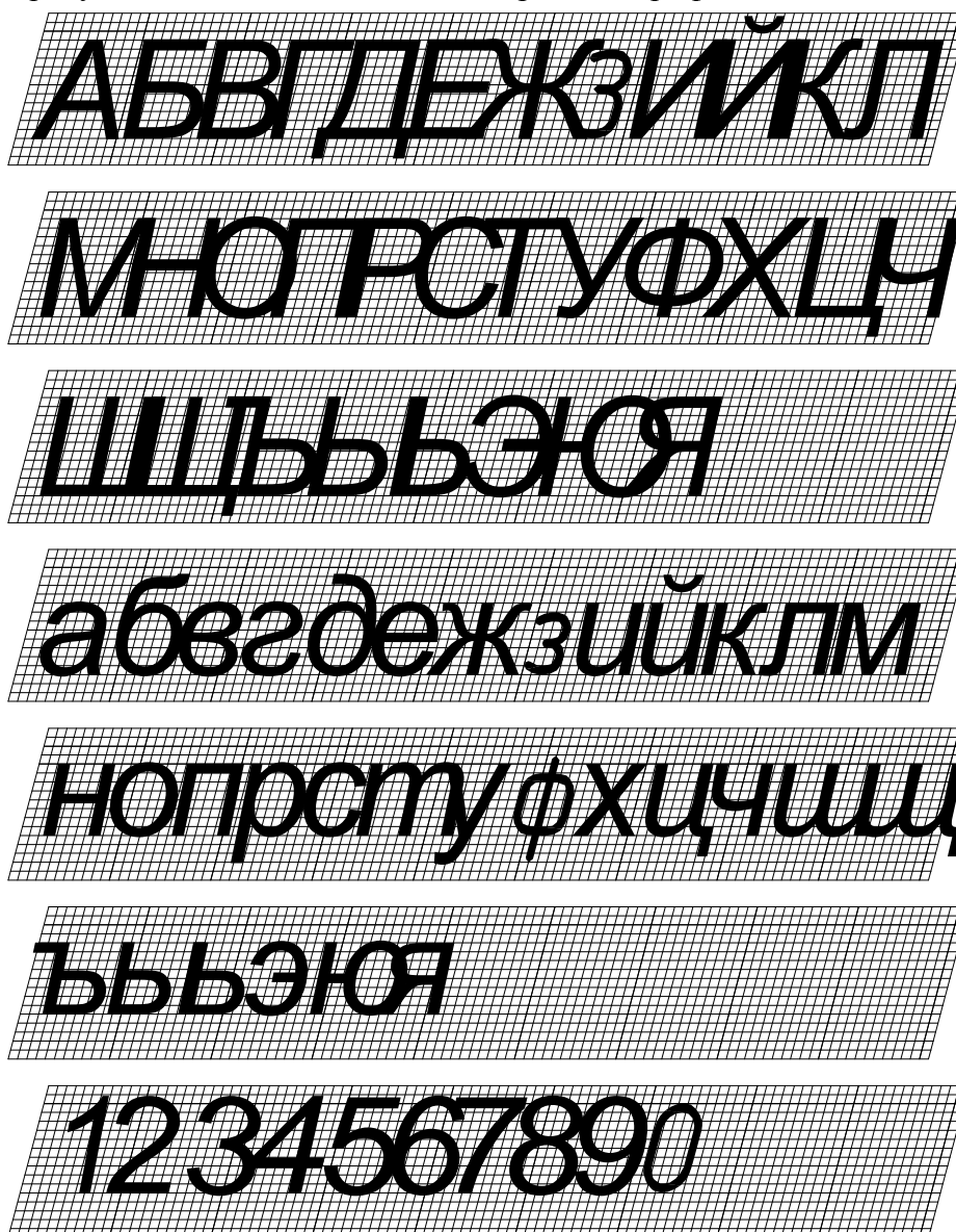
Рисунок 6 – Шрифт чертежный типа Б с наклоном
