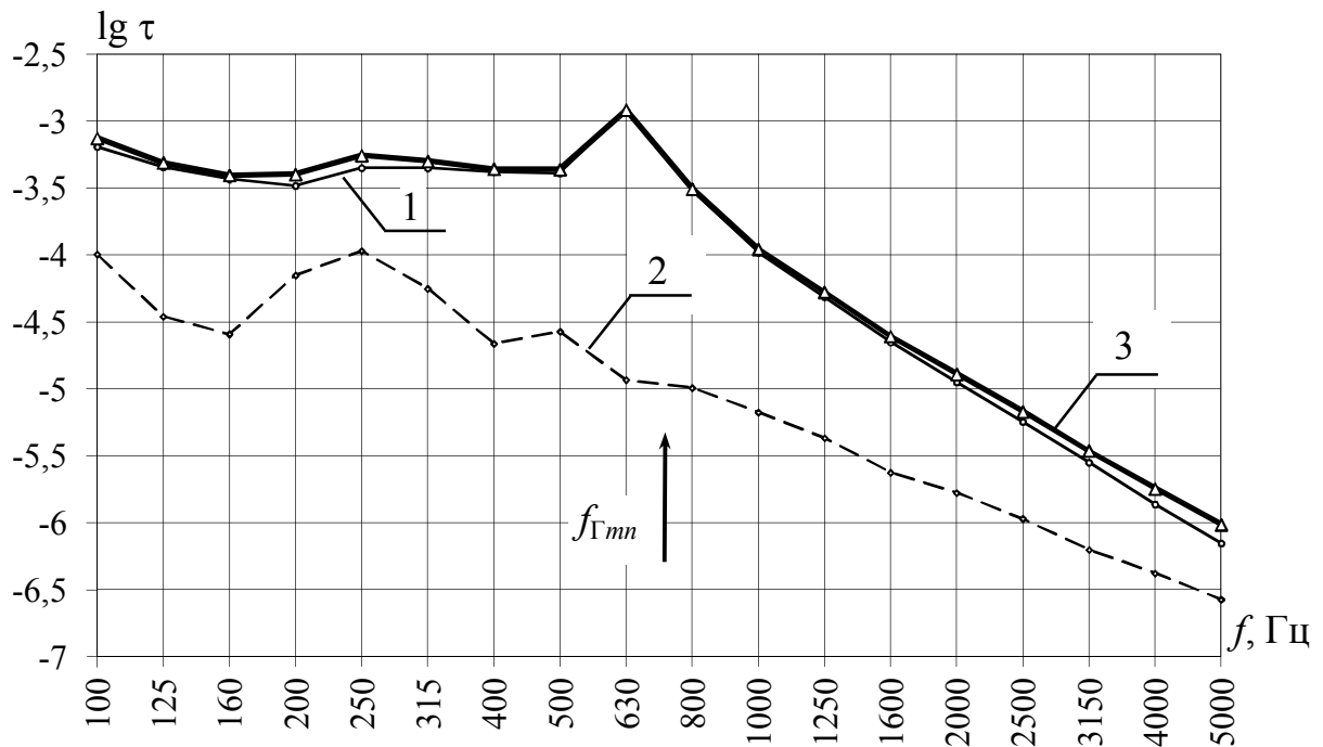
Рис. 3.24. Частотные характеристики коэффициентов прохождения звука для ГБ панели до ОПС ( h = 80 мм; D/\mu = 741 м 4 /с 2 ): 1 – коэффициент резонансного прохождения звука \tau_c ; 2 – коэффициент инерционного прохождения звука \tau_i ; 3 – общий коэффициент прохождения звука \tau
