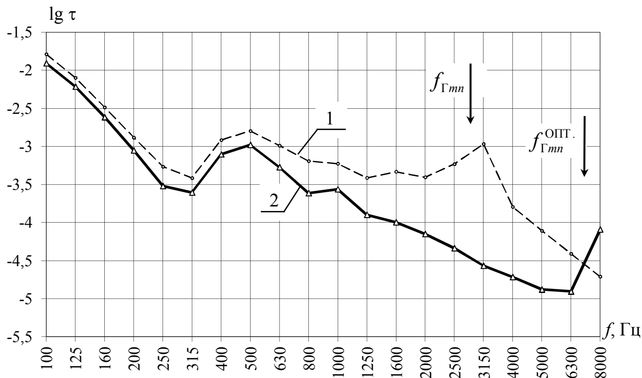
Рис. 3.18. Частотные характеристики общего коэффициента прохода звука для ГВЛ: 1 – до ОПС ( h = 12,5 мм; D/\mu = 48,3 м 4 /с 2 ); 2 – после оптимального ОПС ( h_{\text{ОПТ.}} = 6 мм; D_{\text{ОПТ.}}/\mu = 6,0 м 4 /с 2 )
