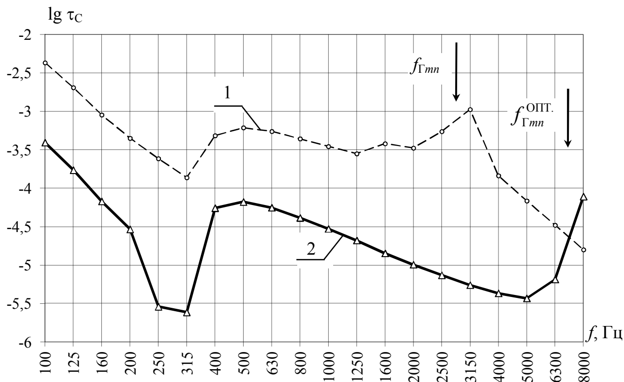
Рис. 3.15. Частотные характеристики коэффициента резонансного прохождения звука для ГВЛ: 1 – до ОПС ( h = 12,5 мм; D/\mu = 48,3 м 4 /с 2 ); 2 – после оптимального ОПС ( h_{OPT.} = 6 мм; D_{OPT.}/\mu = 6,0 м 4 /с 2 )
