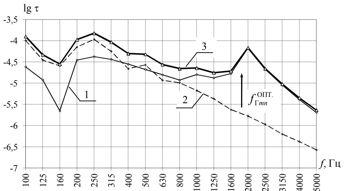
Рис. 3.25. Частотные характеристики коэффициентов прохождения звука для ГБ панели после ОПС ( h_{\text{ОПТ.}} = 40 мм; D_{\text{ОПТ.}}/\mu = 92,5 м 4 /с 2 ): 1 – коэффициент резонансного прохождения звука \tau_c ; 2 – коэффициент инерционного прохождения звука \tau_i ; 3 – общий коэффициент прохождения звука \tau
