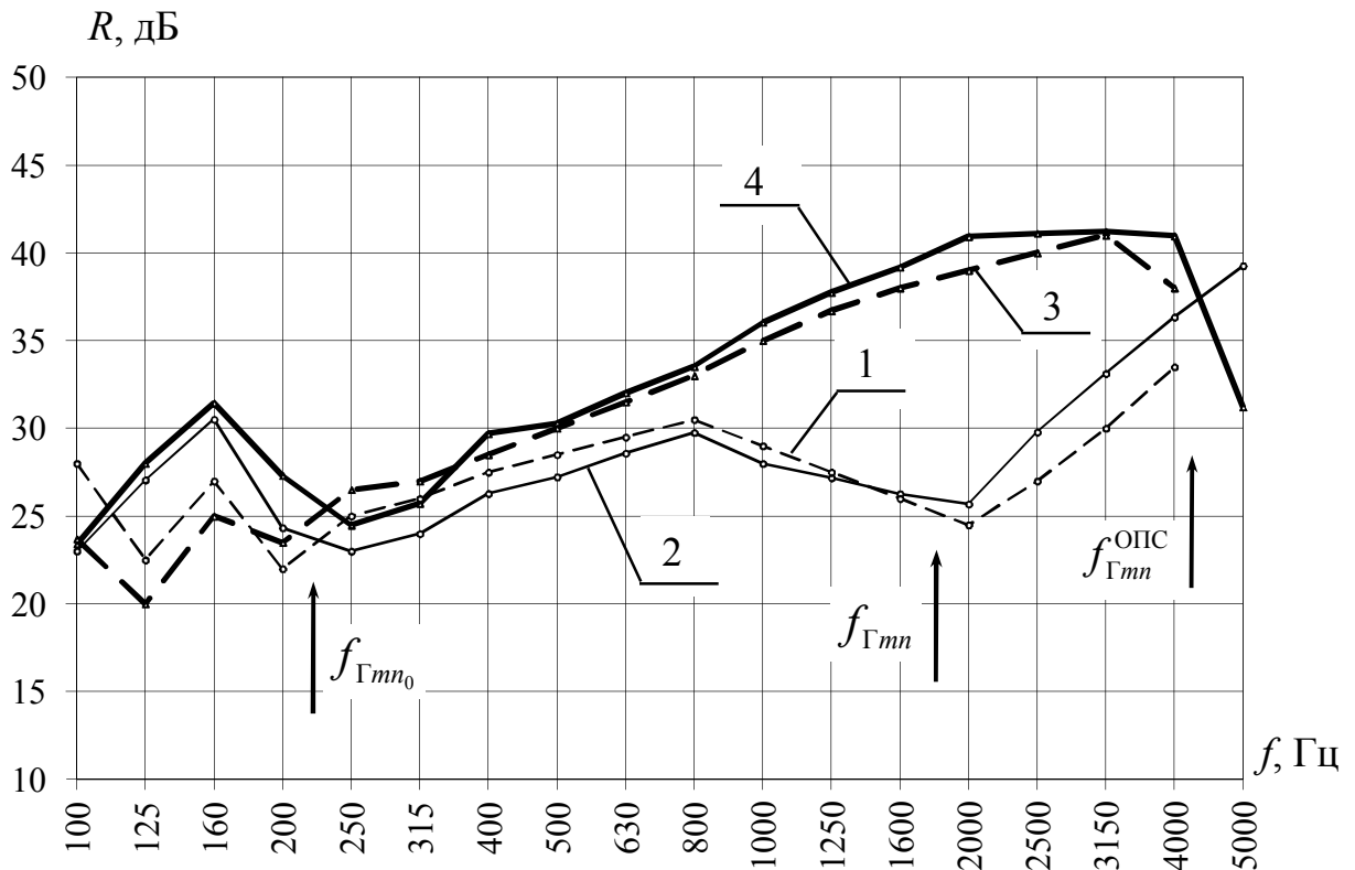
Рис. 4.10. Частотные характеристики звукоизоляции ДСП с ОПС ( a \times b = 1,2 \times 1,08 м): 1 – экспериментальная кривая до ОПС ( h = 23 мм, D/\mu = 115,6 м 4 /с 2 ); 2 – теоретическая кривая до ОПС; 3 – экспериментальная кривая после ОПС ( \delta = 11,5 мм, h_{\text{П.}} = 11,5 мм; D_{\text{П.}}/\mu_{\text{П.}} = 16,4 м 4 /с 2 ); 4 – теоретическая кривая после ОПС
