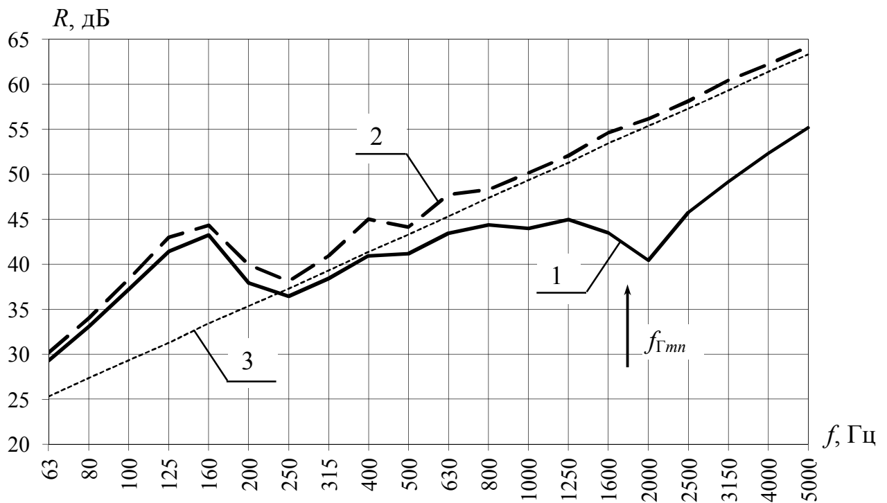
Рис. 2.3. Частотные характеристики звукоизоляции гипсобетонной панели с ОПС ( a \times b = 1,8 \times 1,0 м; h_{\text{П}} = 40 мм; \delta = 40 мм; \mu = 69,5 кг/м 2 , D = 7704 Па м 3 ): 1 – теоретическая кривая; 2 – кривая предельной звукоизоляции панели; 3 – закон масс
